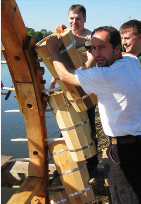
Abb. 12: Die Kümpfe werden angebracht und mit Kumpfnägeln befestigt
