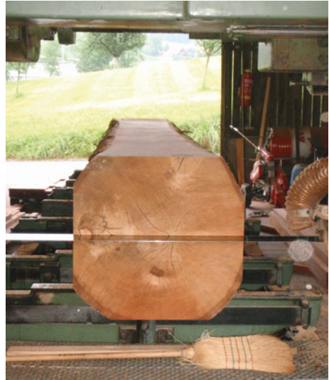
Abb. 24: ... Eichenstamm wird halbiert
