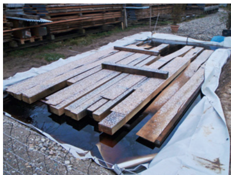
Abb. 29: Das Eichenholz wird gewässert
