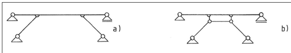
Abb. 7: Statische Systeme des Trapezsprengwerkes – a) Trapezsprengwerk mit durchlaufendem Streckbalken, b) Trapezsprengwerk mit getrenntem Spannriegel
