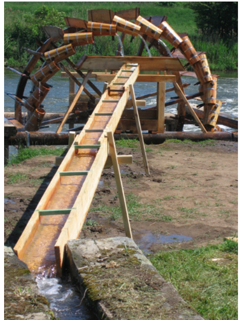
Abb. 14: Der Fangbaum ist entfernt, das Schöpfrad dreht sich und das Wasser fließt durch die Rinne zum Bewässerungssystem
