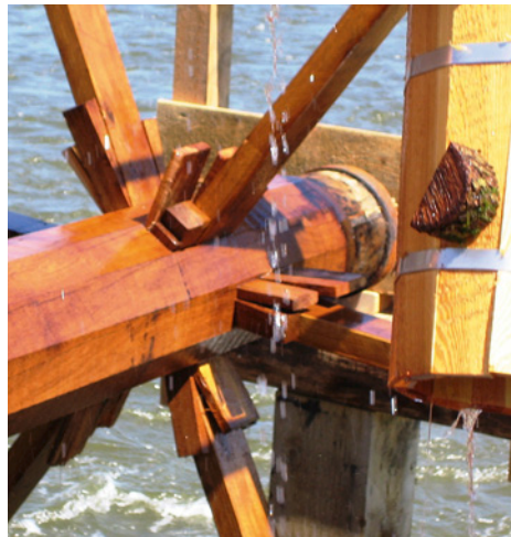
Abb. 11: Die Arme sind mit der Welle verkeilt
