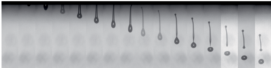
Abbildung 11.23: Exemplarische stroboskopische Aufnahme des Tropfenbildungsprozesses mit Satellitentropfenbildung. Die Düse hat hierbei einen Querschnitt von 70 \times 70 \mu\text{m}^2 mit einer Länge von 50 \mu\text{m} . Ansteuerung mit 40 V und einer Pulsdauer von 50 \mu\text{s} . Abstand der Bilder je 20 \mu\text{s} .
