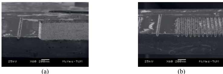
Abbildung 10.9: Rasterelektronenmikroskopische Aufnahmen zu dem Einfluss des Linienabstandes auf den Materialabtrag. Vermalige Überführung in (a) mit einem Linienabstand von \Delta y = 25 \mu\text{m} und in (b) mit keinem Überlapp. Entnommen aus Kagerer, Irlinger und Lueth (2012).
