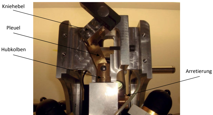
Abbildung 9.11: Umgesetzte Kinematik des Greif- / Absetzwerkzeuges in Form eines zentrischen Schubkurbelgetriebes.
