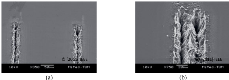
Abbildung 10.5: Rasterelektronenmikroskopische Aufnahmen von Laserlinien mit (a) keinem SÜ und (b) mit einem Abstand von 30 \mu\text{m} . Entnommen aus Kagerer, Irlinger und Lueth (2011).
