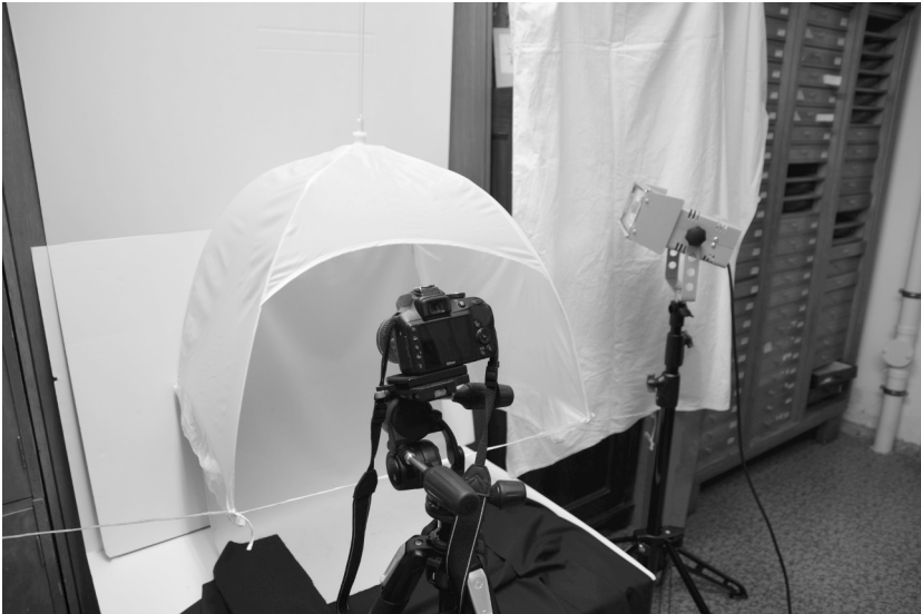
Abbildung 3: Lichtzeltkonstruktion für Fotoaufnahmen. Foto: Jörg Neumann.
