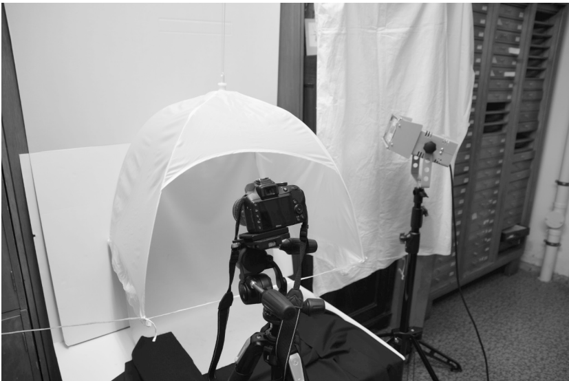
Abbildung 3: Lichtzeltkonstruktion für Fotoaufnahmen. Foto: Jörg Neumann.
