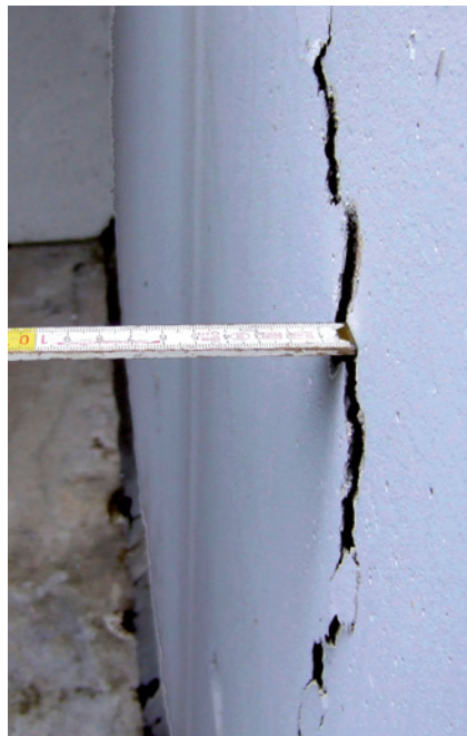
Bild 2.18 Das hintere Rissufer hat sich aus der Wand- ebene in den Raum hinein verschoben
