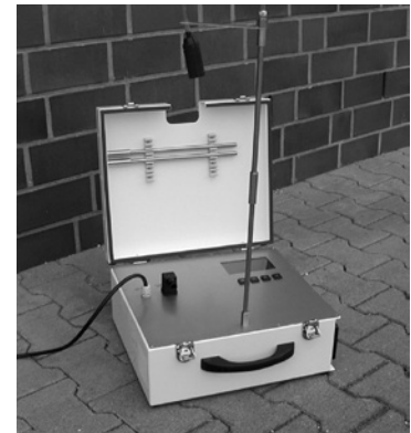
Abb. 1.4-2: Gerät zur Entnahme von Proben aus der Raumluft mit einem festgelegten Volumenstrom
