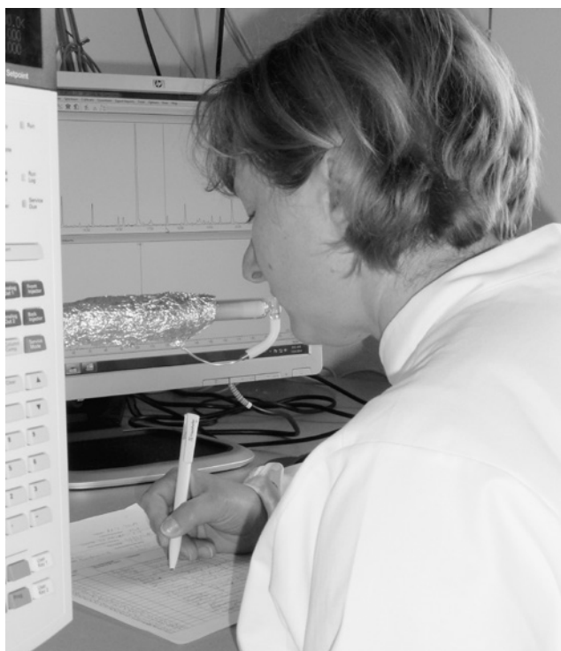
Abb. 2.2-5: Aroma-Chemikerin identifiziert geruchsaktive Stoffe mittels Gaschromatografie-Massenspektrometrie und olfaktometrischer Detektion.
