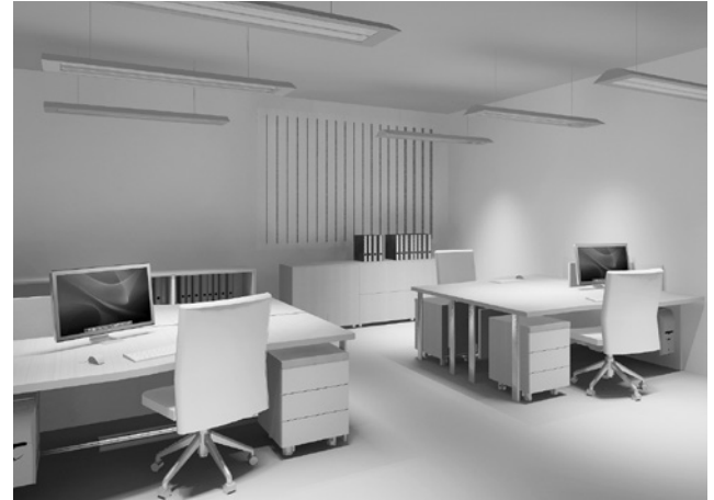
Abb. 2.3-17: Beispiel für eine biologisch wirksame Bürobeleuchtung. Das Tag-Szenario (links) zeichnet sich durch eine flächige Aufhellung des oberen Raumes mit einer kühlen Lichtfarbe aus. Für das Abend/Nacht-Szenario wird eine warme Lichtfarbe benutzt und das Licht wird nur zur Beleuchtung der Sehaufgaben eingesetzt.
