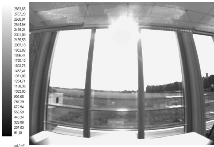
Abb. 2.3-20: Wirkung von Sonnen- und Blendschutzsystemen: Leuchtdichten auf der Fassadeninnenseite. Unverschattete Fassade (links), Fassade mit transparenter Sonnenschutzfolie (rechts), Lamellenraffstore unten geschlossen, Lichtlenkung oben (nächste Seite links), Lamellenraffstore mit geöffneten Lamellen (nächste Seite rechts). Das deutlich sichtbare Abbild der Sonne in Bild 1, 2 und 4 kann störende Direktblendung verursachen.
