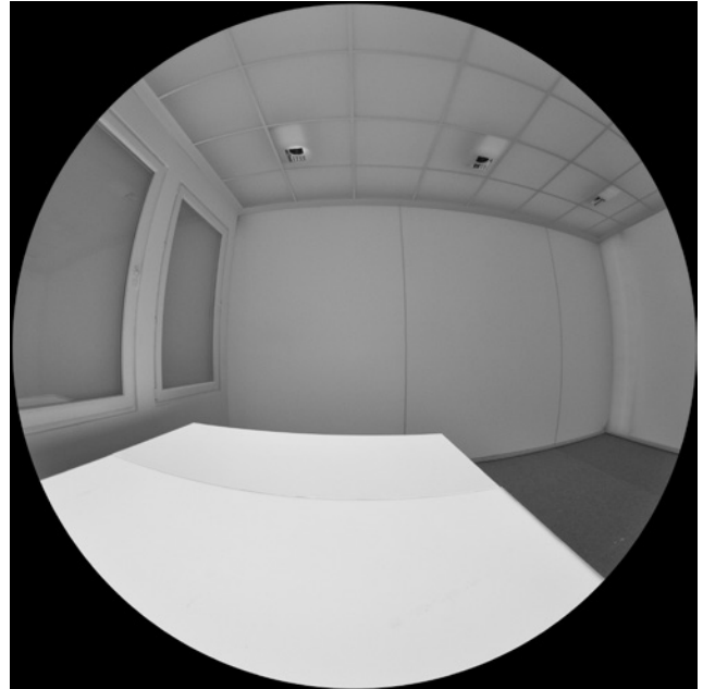
Abb. 2.3-13: Lichtlösungen mit vergleichbarem Energieverbrauch: Eine Beleuchtung laut Norm (links), und eine Beleuchtung mit gleicher Beleuchtungsstärke auf dem Arbeitstisch, niedrigerem Beleuchtungsniveau im Umgebungsbereich und einer höheren Wand- und Deckenbeleuchtung, welche von Versuchspersonen besser bewertet wird (Kirsch & Völker, 2013).
