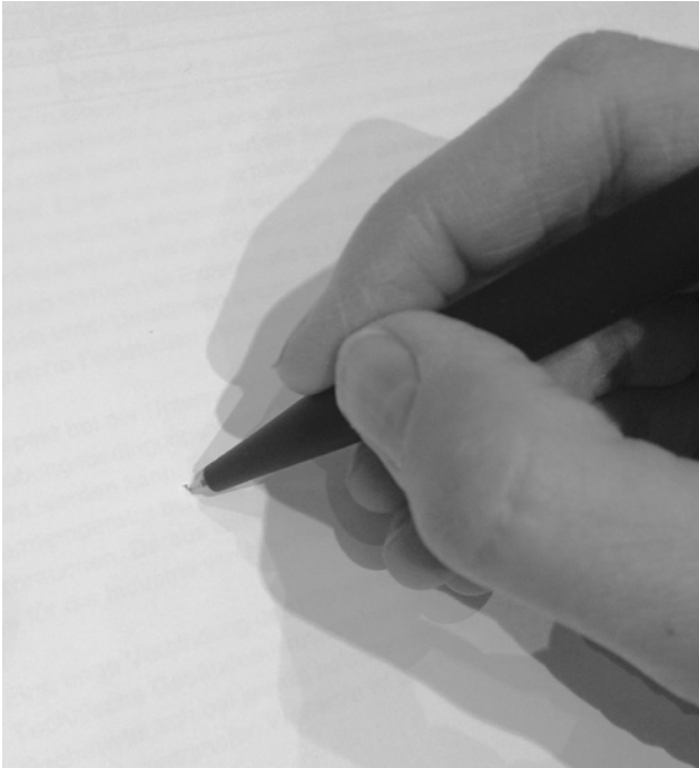
Abb. 2.3-14: Mehrfachschatten, verursacht durch eine Leuchte mit sichtbarem LED-Array
