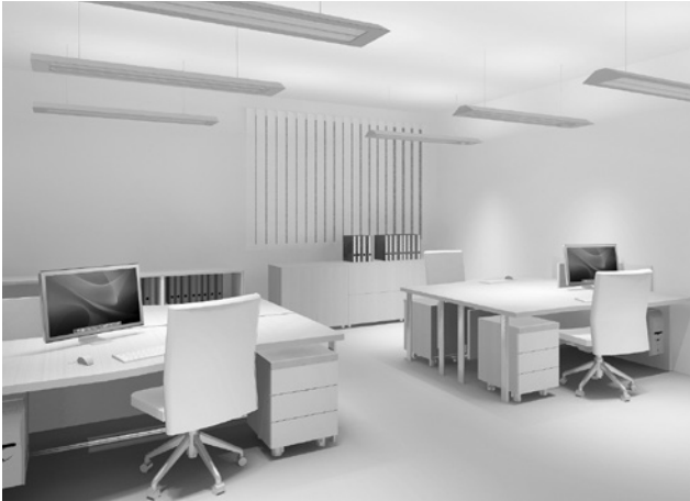
Abb. 2.3-17: Beispiel für eine biologisch wirksame Bürobeleuchtung. Das Tag-Szenario (links) zeichnet sich durch eine flächige Aufhellung des oberen Raumes mit einer kühlen Lichtfarbe aus. Für das Abend/Nacht-Szenario wird eine warme Lichtfarbe benutzt und das Licht wird nur zur Beleuchtung der Sehaufgaben eingesetzt.
