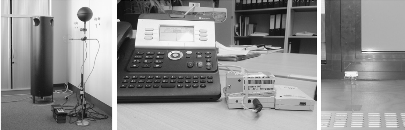
Abb. 2.1-20: Mobile Messtechnik für die Erfassung von Raumklimadaten (Lufttemperatur, operative Temperatur, Luftgeschwindigkeit, CO 2 -Konzentration in der Raumluft und relative Luftfeuchte (links, Mitte)) und Nutzerverhalten (Öffnen und Schließen von Fenstern (rechts)).
