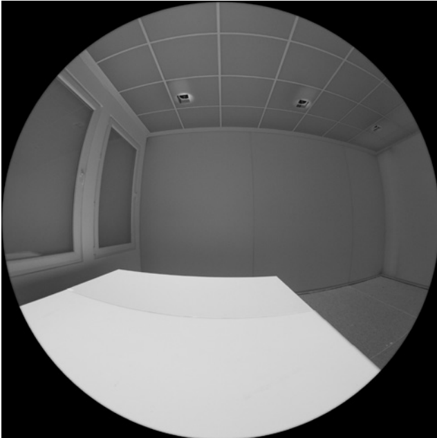
Abb. 2.3-13: Lichtlösungen mit vergleichbarem Energieverbrauch: Eine Beleuchtung laut Norm (links), und eine Beleuchtung mit gleicher Beleuchtungsstärke auf dem Arbeitstisch, niedrigerem Beleuchtungsniveau im Umgebungsbereich und einer höheren Wand- und Deckenbeleuchtung, welche von Versuchspersonen besser bewertet wird (Kirsch & Völker, 2013).
