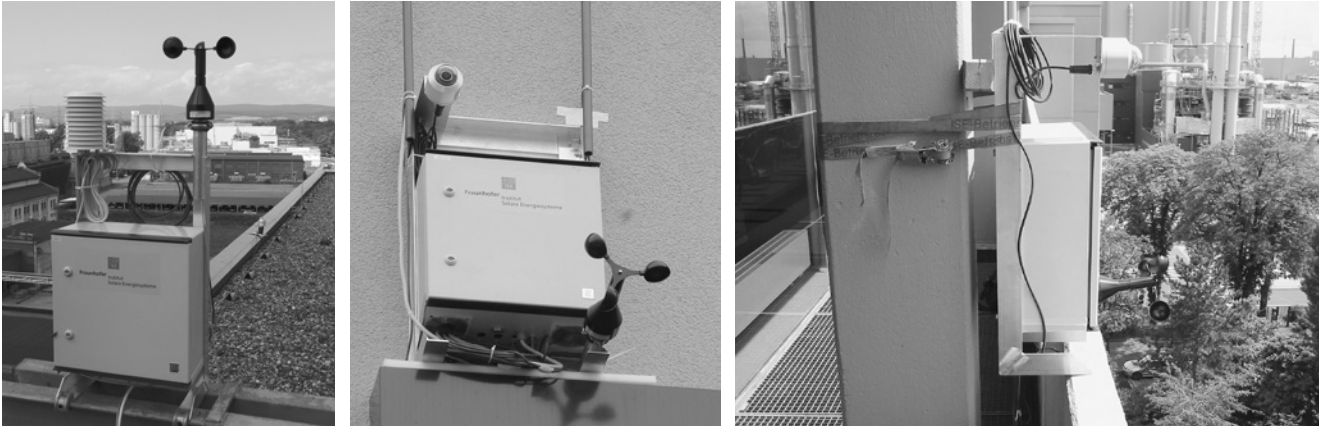
Abb. 2.1-19: Mobile Messtechnik für die Erfassung von Wetterdaten und Mikroklima an der Fassade.
