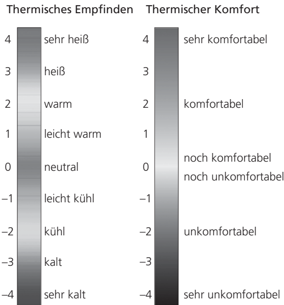
Abb. 2.1-8: Beurteilungsskalen des thermischen Empfindens und der thermischen Behaglichkeit des UCB-Modells (Übersetzung aus dem Englischen) in Anlehnung an EN ISO 10551
