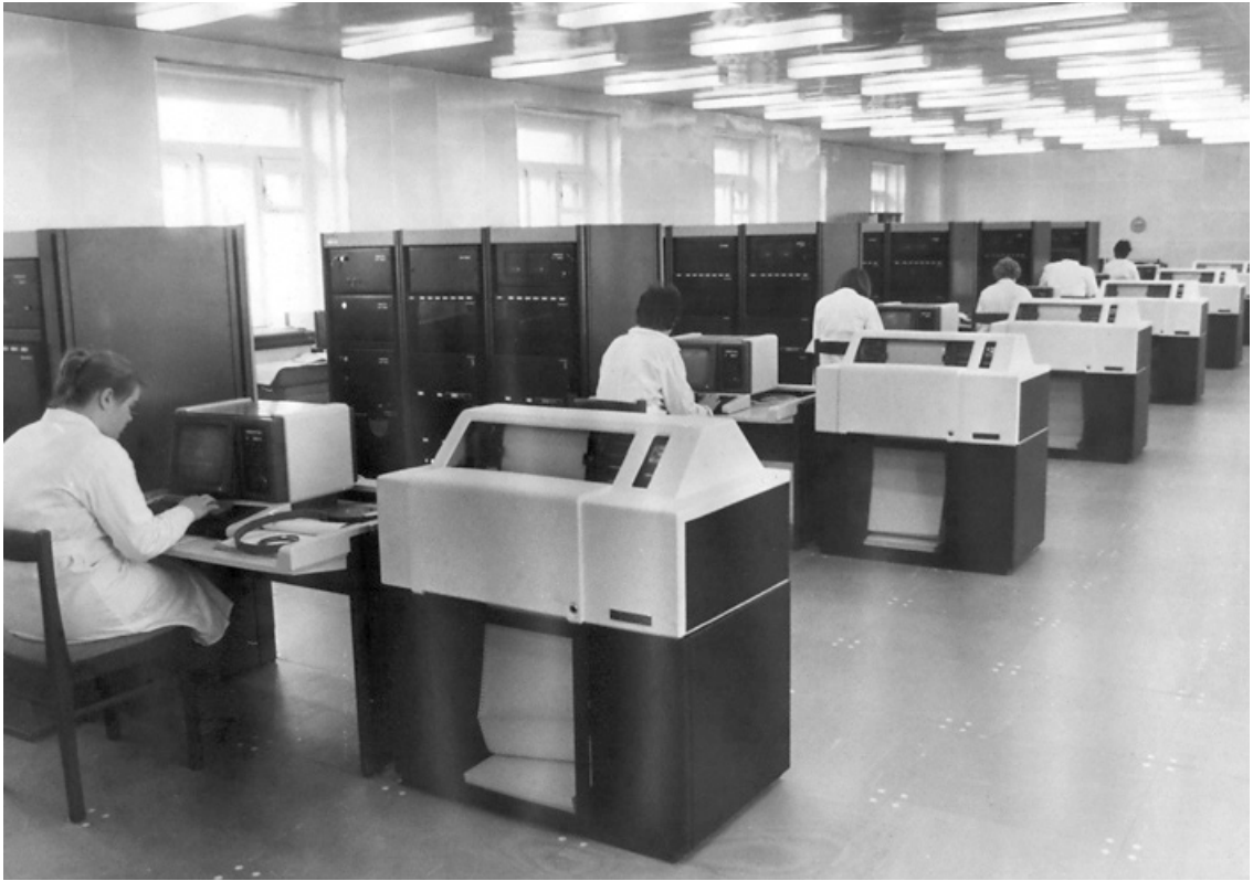
Abb. 1 K-1600-Computer in einer sowjetischen Forschungseinrichtung, Mitte der 1980er Jahre in Kirow. Links die Rechen-einheit mit Festplatten, in der Mitte die Bedieneinheit und rechts der Drucker
