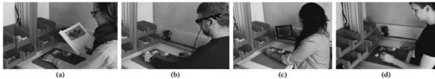
Bild 4: Evaluierung verschiedener Feedbackmodalitäten hinsichtlich der benötigten Zeit für die Fertigstellung sowie der Anzahl der Fehler während der Verbauung. (a) Papieranleitung, (b) Augmented Reality Anleitung mit direkter Projektion auf eine Datenbrille, (c) Tabletanleitung, (d) Projektionsbasierte Anleitung.
