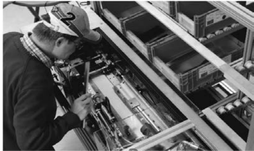
Bild 3: Montagearbeiter setzt eine Schraubzwinge mit Hilfe von In-Situ Feedback zusammen.
