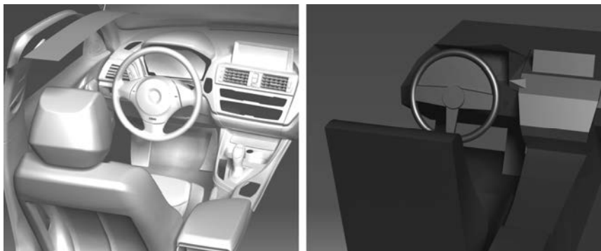
Bild 2: Referenzfahrzeug BMW 1er (links; CAD-Daten wurden freundlicherweise von der BMW AG zur Verfügung gestellt) und vereinfachte Variante des BMW 1er (rechts)
