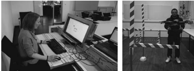
Bild 6: Probanden während des jeweiligen Versuchs: Evaluation der Benutzungsschnittstelle des Bildschirmarbeitsplatzes (links), Untersuchung textueller Warnmeldungen in Datenbrille bei der Teleoperation (rechts).
