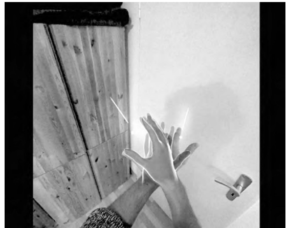
Abb. 2 Screenshot der Hände im Passthrough-Modus der Meta Quest 3. Die abgefilmten Hände werden von den erfassten Handposen überlagert, was im Falle von Verdeckungen zu Trackingfehlern führt
