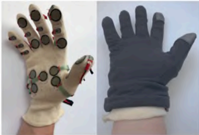
Abbildung 3.4: Sensorhandschuh zur Bestimmung von Lastkollektiven (Odendahl, 2017)
