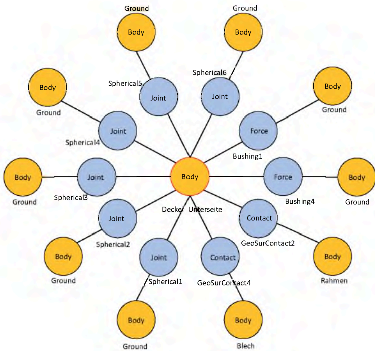
Abbildung A 7: Randbedingungen und Wechselwirkungen des Bauteils Deckel_Unterseite . Orange hinterlegt: Körper; blau hinterlegt: Bedingung
