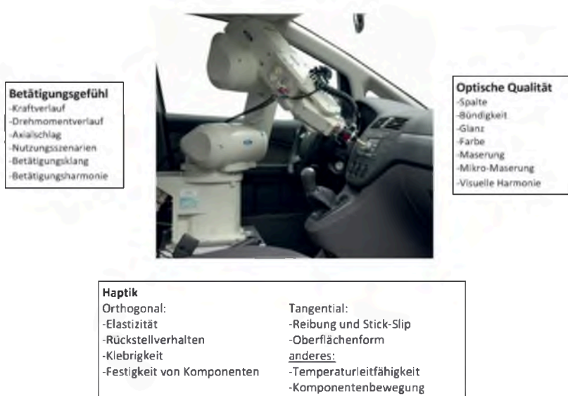
Abbildung 2.18: Erfassbare Parameter der RUTH (Robotized Unit for Tactility and Haptics) nach Spingler (2011)
