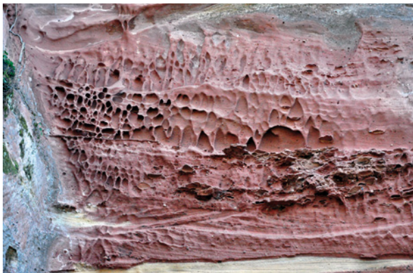
Bild 51 ■ Alveolarverwitterung einer Gesteinsoberfläche
