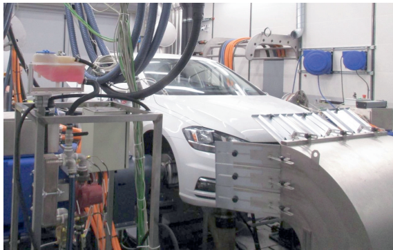
Abbildung 103: klassische Konditionierung an Fahrzeugprüfständen mittels Prüfstandsgebläse
