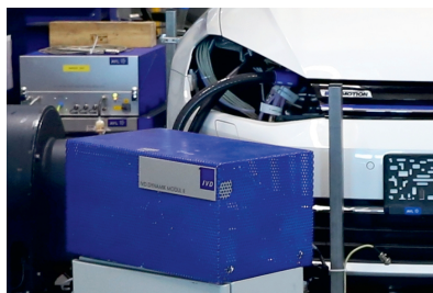
Abbildung 105: Anbindung des dynamischen Konditioniersystems an den Fahrzeugkreislauf
