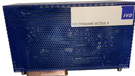
Abbildung 101: Gesamtansicht der dynamischen Medienkonditionierung für 25 kW Kühlleistung
