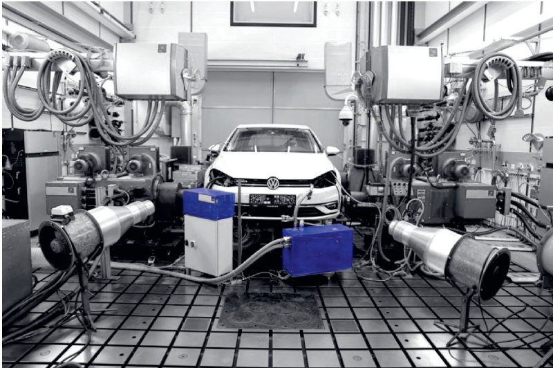
Abbildung 104: Einsatz eines dynamischen Konditioniersystems mit 25 kW bzw. 150 kW für den Niedertemperatur- (links) und den Hochtemperaturkreislauf (rechts) am Antriebsstrangprüfstand
