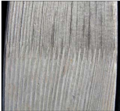
Abb. 2: Intakte Keilzinkung bei einem Terrassenbrett aus Lärchenholz nach 3 Jahren Bewitterung
