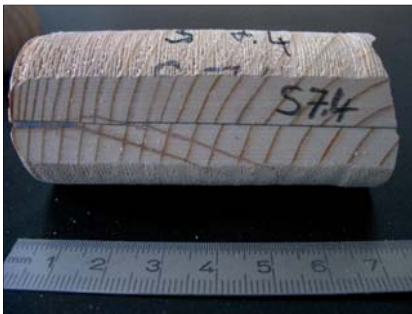
Abb. 3: Bohrkern mit angeschnittenen parallelen und ebenen Flächen für die Scherprüfung
