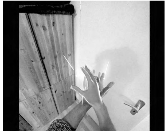
Abb. 2 Screenshot der Hände im Passthrough-Modus der Meta Quest 3. Die abgebildeten Hände werden von den erfassten Handposen überlagert, was im Falle von Verdeckungen zu Trackingfehlern führt
