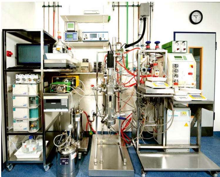
Bild 3.3: Hochinstrumentierter Forschungsbioreaktor BIOSTAT® C10
