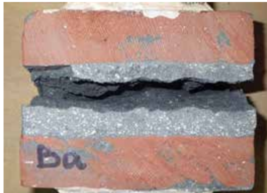
Bild 24 Haftzugfestigkeitsprüfung nach dem Prüfverfahren ibac-1 (siehe auch Bild 23)
