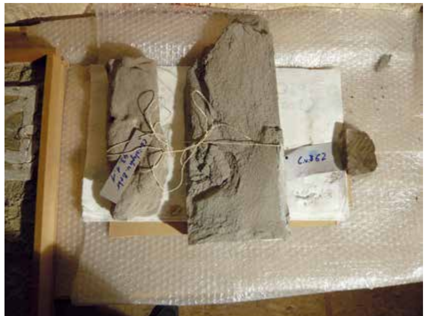
Bild 5 Rückseiten verschiedener Bauteile mit Strukturschädigung des Sandsteins
