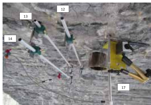
Bild 13 Messstellen im Gewölbescheitel des Hauptbogens
