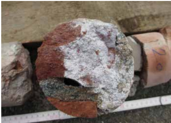
Bild 27 extreme Schadstoffanreicherungen in Mauerwerks-hohlräumen in Übersicht (links) und im Detail (rechts)
