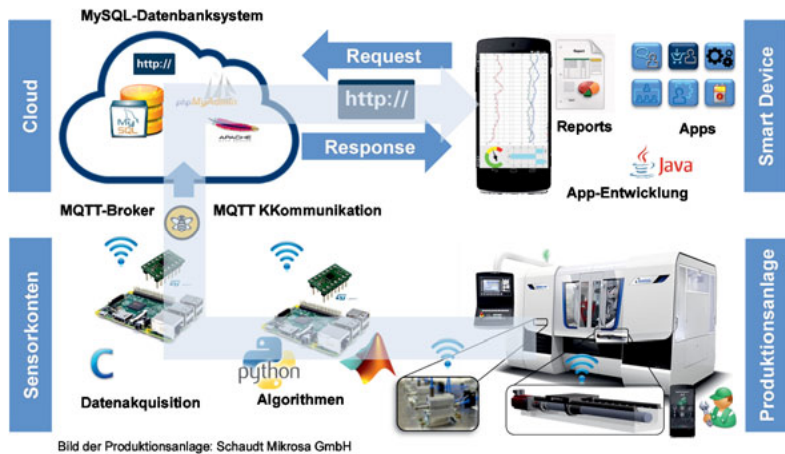
Abbildung 4: Kommunikationsarchitektur des Sensornetzwerks in der Datenanalyse
