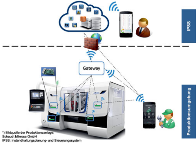
Abbildung 2: Installation eines Funksensornetzwerks an der Produktionsanlage [2]
