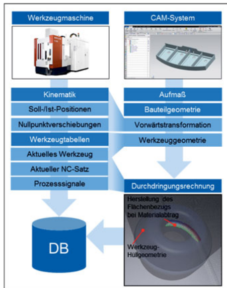
Abbildung 5: Herstellung des Bezuges zwischen NC-Satz, Werkzeug sowie Prozesssignalen und Bauteiloberfläche (Bildquellen: Heller, Siemens)
