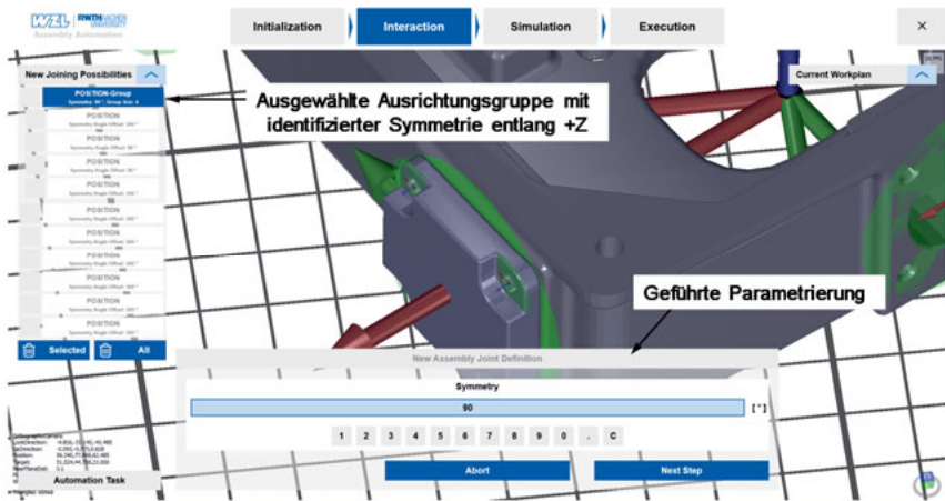
Abbildung 5: Darstellung der Parametrierung einer Montageverbindung.
