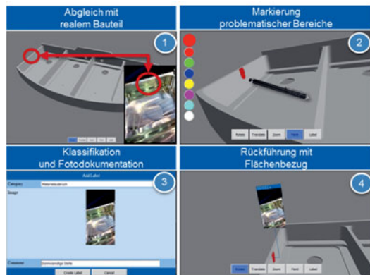
Abbildung 3: Dokumentation von Fertigungsfehlern auf mobilen Endgeräten
