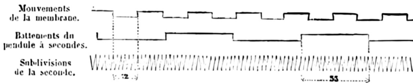
Abbildung 9: Das visuelle Regime der Elektrochronographie zur Errechnung räumlicher Entfernung auf Basis des Delays eines akustischen Impulses bei Bontemps.
