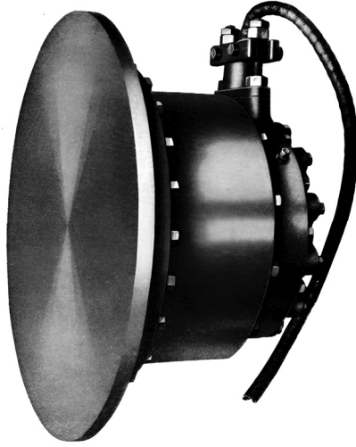
Abbildung 24: Der Fessenden-Oszillator. Grafik aus dem Jahr 1920.
