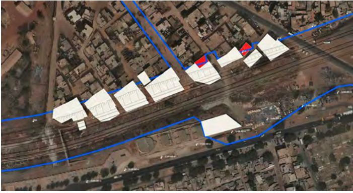
Abb. 22: Luftaufnahme mit technischer Zeichnung des Sicherheitsperimeters des TER-Bahntrasse (blaue Linie) in Bargny, 2024, Dakar. Die weiß markierten Gebäude sind direkt vom Abriss betroffen, während die rot markierten Gebäude nur teilweise von den Bauarbeiten tangiert werden. © APIX.
