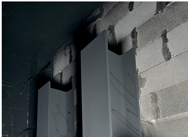
Bild 5. Bauteile nach Verrußung.
