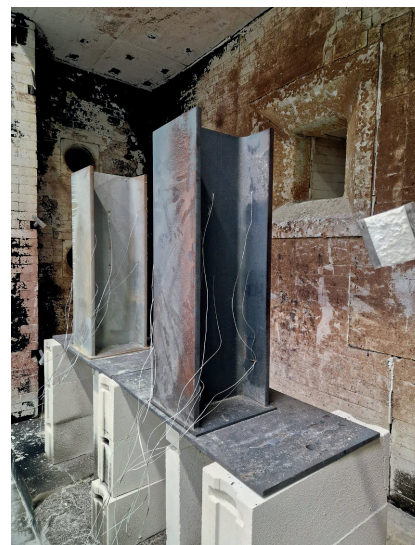
Bild 4. Probekörper vor den Prüfungen. Foto: Interessengemeinschaft Brandschutz-Beschichtungen e.V. (IGSB e.V.) Fig. 4. Test specimens before testing. Source: Interessengemeinschaft Brandschutz-Beschichtungen e.V. (IGSB e.V.)
