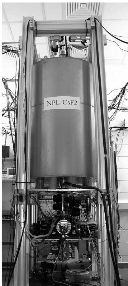
Abb. 5: Atomuhr (Mit freundlicher Genehmigung des National Physical Laboratory in Teddington)
