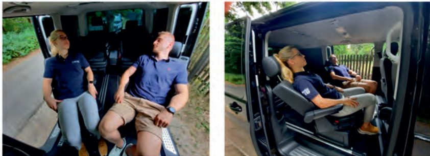
Bild 2: Kommunikationsmodus mit einem Drehwinkel von 30° und geneigter Lehne (40° zur Vertikalen, Arbeitsmodus) in einem Volkswagen T6 (Baujahr 2015)
