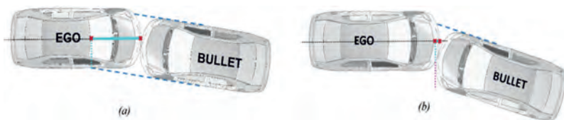
Bild 2: Methoden zur Bestimmung des seitlichen Überdeckungsgrads des Ego-Fahrzeugs bei einer Frontkollision. Die türkise Linie zwischen den beiden roten Punkten stellt den seitlichen Überlapp dar.
