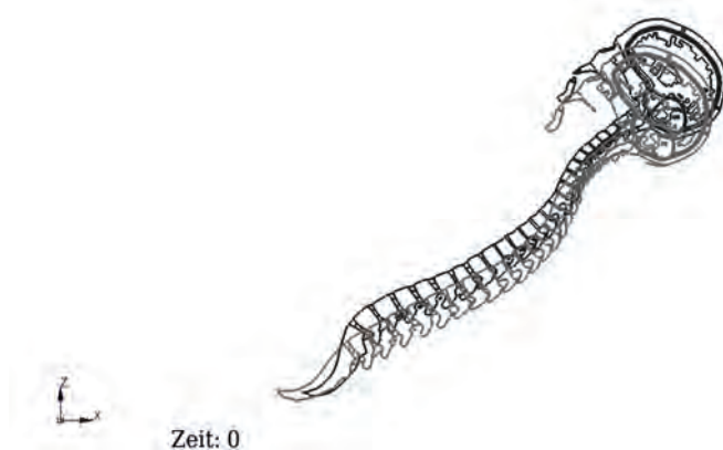
Bild 9: Vergleich der Wirbelsäulenkrümmung: vermessener Proband (grau) und THUMS v4 (schwarz)
