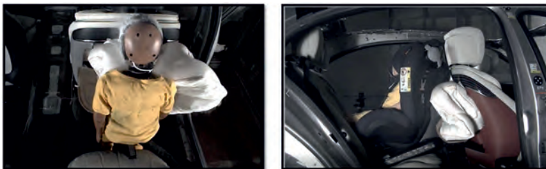
Bild 9: Out of Position- und Kindersitz Versuch mit teilentfaltetem Fond Airbag
