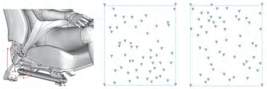
Bild 3: Submarininguntersuchung– aufrechter Sitzposition (Designraum THUMS links/ THOR rechts, jeweils x-z-Ebene)
