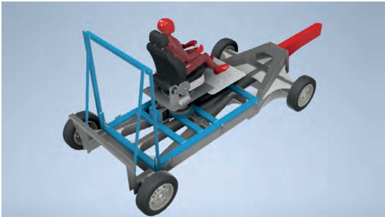
Bild 8: Konzept eines Aufbaus zur automatisierten Sitzverstellung während einer Pre-Crash-Phase auf einem Crashtestschlitten [15]
