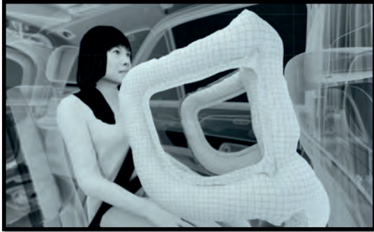
Bild 7: Röhrenstruktur des Fondairbags in entfaltetem Zustand
