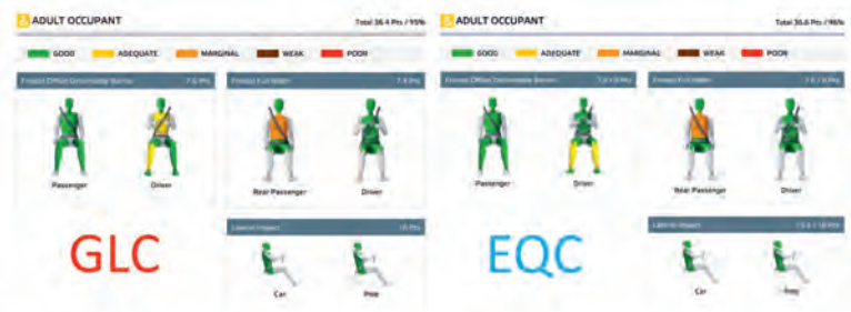
Bild 6: EuroNCAP-Vergleich Insassenbelastungen GLC mit EQC
