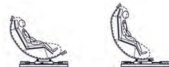
Bild 7: Rückhaltung aus rückwärtsgerichteter Normalsitzposition
