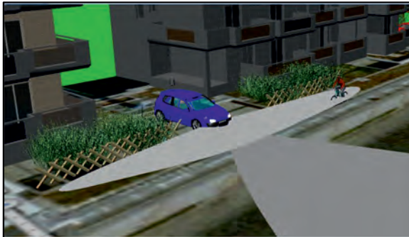
Bild 8: Schematische Darstellung eines erweiterten Notbremsassistenten mit Erkennung von Radfahrenden (AEB+), dessen Sensoren einen sich nähernden Radfahrende auch bei Sichtbehinderung erkennen
