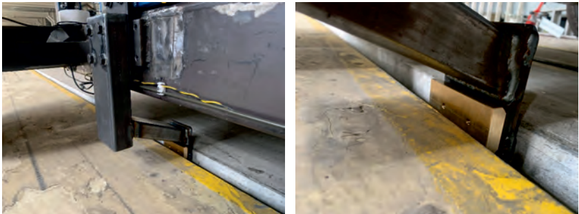
Bild 6: Führungssystem am Crashtestschlitten
