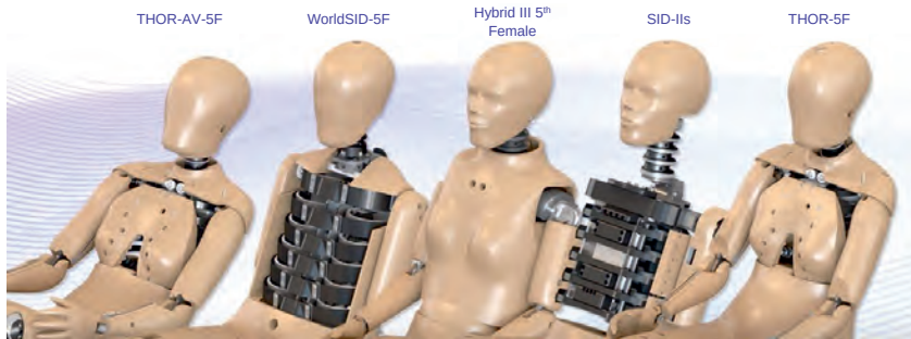
Bild 3: Existierende Dummies, die etwa der Anthropometrie einer 5-Perzentil-Frau entsprechen (Quelle: Humanetics)
