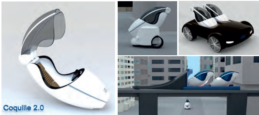
Bild 1: IAV-Coquille 2.0 Wechselkonzept der Antriebseinheit
