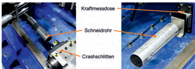
Bild 11: Schneidabsorber unterhalb der Tür (Schwellerbereich)
