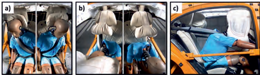
Bild 10: Schlittenversuch: Beltbag und Fondairbag im Vergleich zum Standard-Rückhaltesystem
