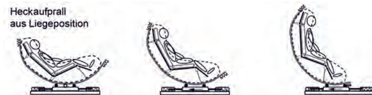
Bild 8: Rückhaltung bei rückwärtsgerichteter Liegeposition
