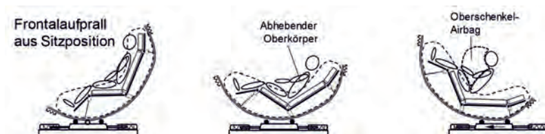
Bild 5: Rückhaltung bei unvollständiger Sitzrotation und abhebendem Oberkörper
