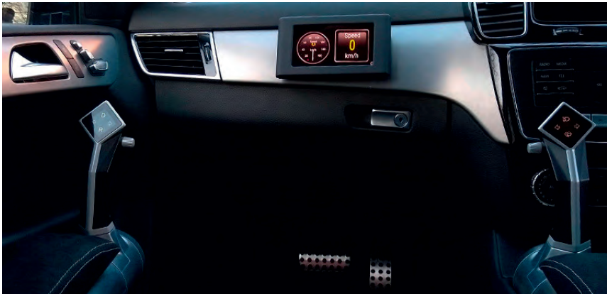
Bild 8: Frühes Konzept eines PKW-Cockpit mit Sidesticks als Steuerelemente [7]
