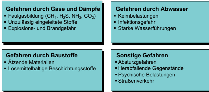
Abbildung 4-2: Gefahren bei der Arbeit in und an abwassertechnischen Anlagen
