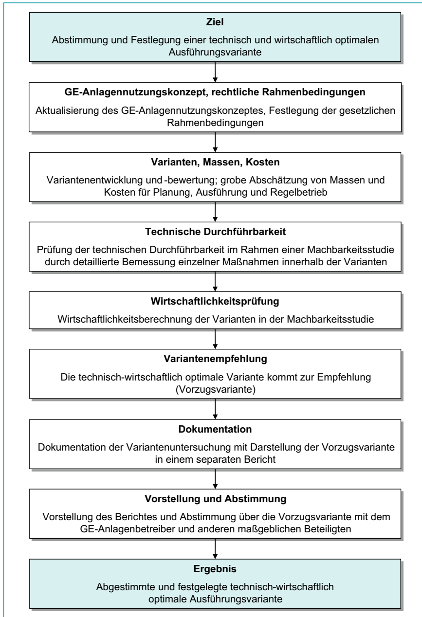
Abbildung 3-6: Bearbeitungsschritte zur Gestaltung einer Ausführungsvariante
