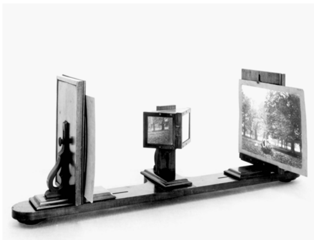
Abb. 25: Reflexionsstereoskop von Charles Wheatstone, London, ca. 1850.
