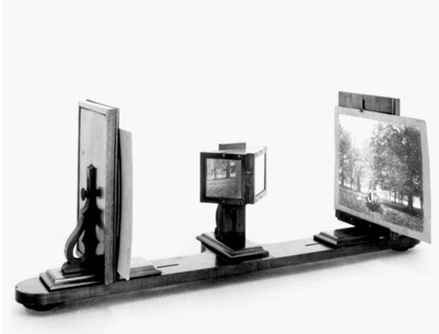
Abb. 25: Reflexionsstereoskop von Charles Wheatstone, London, ca. 1850.
