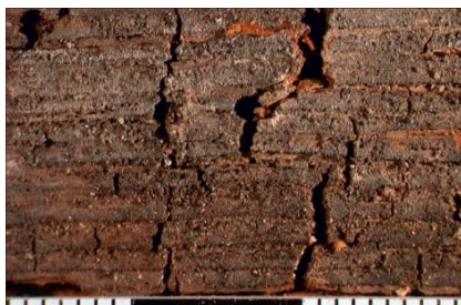
Abb. 6: Moderfäule mit Würfelbruch, der sich kaum von einer Braunfäule unterscheidet; Maßstab mit Millimetern.
