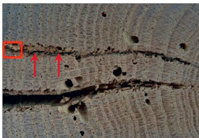
Abb. 41: Detail von Abb. 40 (siehe Kasten): kleinräumiger Kombinationsbefall in den eingeschlossenen Holzrisen/-spalten: jüngere Larven des Bunten Nagekäfers fressen in den stärker mit Moderfäulepilzen und Bakterien befallenen Bereichen (↑).
