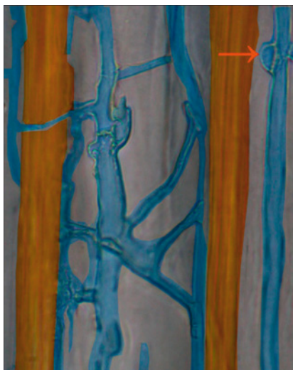
Abb. 9: Fehlfarben-Darstellung der Substrathyphen des Ausgebreiteten Hausporlings im Holz in ca. 1000-facher Vergrößerung; braun : Holz; blau : oft eng am Holz anliegende Hyphen; in der Anfangsphase sind fein verästelte Hyphen mit Schnallen (!) sichtbar, aber kaum Veränderungen des Holzes erkennbar.
