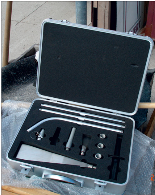
Abb. 15: Strahldüsensatz (Bildquelle: Firma Bennert)
