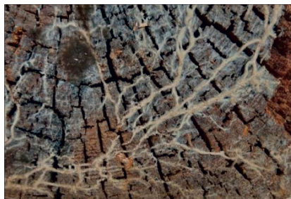
Abb. 17: Weiße, eisblumenähnliche Stränge eines Porenschwammes von einem Balkenkopf.
