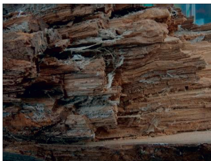
Abb. 24: Echter Hausschwamm: Riegel mit einer massiven Braunfäule, durchzogen von Mycelien und feinen weiß-grauen Strängen, nach dem Ausbau.
