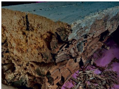
Abb. 21: Fachwerk-Ständer nach dem Ausbau; eine Seite fast intakt; andere Seite mit massiver Braunfäule durch den Echten Hausschwamm/Schwammholzkäfer ( Priobium sp.).
