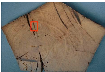
Abb. 40: Bauteil aus einem Turm; der alte Eichen-Stiel wirkt intakt und ist nagelfest, abgesehen von den Fraßgängen des Bunten Nagekäfers ( Xestobium rufovillosum ); Material von R. OTT (Gammertingen).
