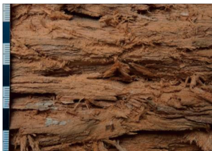
Abb. 5: Pfosten-Reste: Weißfäule mit faserigem Bruchbild, verursacht durch den Ausgebreiteten Hausporling ( Donkioporia expansa ); Maßstab mit Millimetern.
