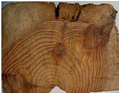
Abb. 53: Kiefernholz-Querschnitt. Fachwerkstiel mit intaktem Kernholz; Splintholz braunfäul und bereichsweise final zerstört; Balken herzogefügt und rissfrei.
