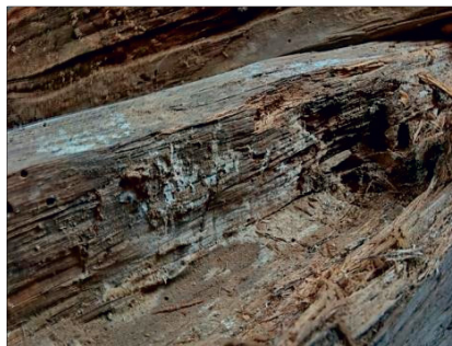
Abb. 48: Doppelbefall: Weißfäuleschaden mit weißem Mycel an einem Zapfenloch durch einen Stachelsporling ( Trechispora spp.) sowie feiner Würfelbruch, verursacht durch den Braunen Kellerschwamm ( Coniophora puteana ).
