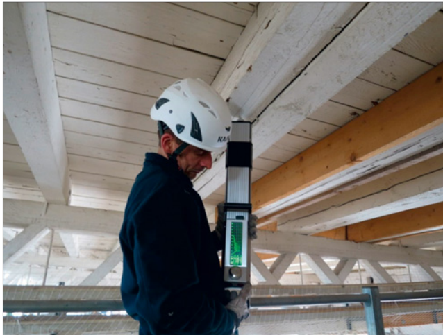
Abb. 2: Bohrwiderstandsmessung mittels Resi PD300 im Praxiseinsatz
