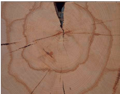
Abb. 54: Eiche: Balken aus nicht herzogefügtem Holz mit tiefem, breitem Riss bis ins Mark (Trocknung zu stark).
