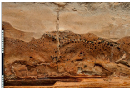
Abb. 32: Ausgebreiteter Hausporling: Braunes, styroporartiges Oberflächenmycel mit weißen Untermycel (oben im Bild); die feinen braunen bis schwarzen Punkte sind die Reste von Guttations-tropfen; Maßstab mit Zenti- und Millimetern.
