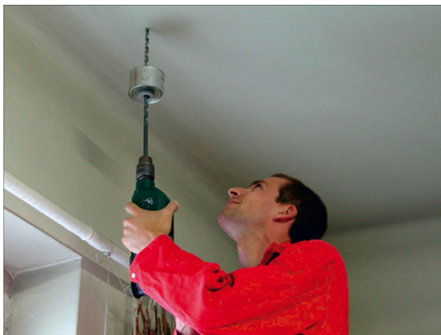
Abb. 1: Bohrwiderstandsuntersuchung einer Deckenkonstruktion
