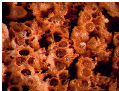
Abb. 35: Ausgebreiteter Hausporling: Detail des Weißfäuleschadens zeigt finalen Abbau des Eichenholz; das Bild zeigt Frühholzgefäße.
