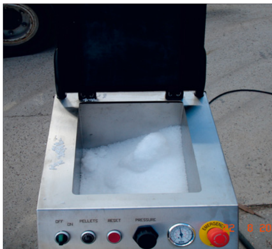
Abb. 13: Vorratsbehälter im Strahlgerät mit Trockeneis gefüllt mit Trockeneis (Bildquelle: Firma Bennert)
