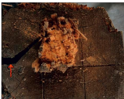
Abb. 14: Brauner Kellerschwamm: Fäuleschaden an einem Zapfen; die Fäule ist nicht in den Ständer eingewachsen und beschränkt sich auf den Zapfen; Würfelbruch fein; Holz nicht herz-getrennt und mit klaffender Spalte (↑).
