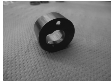
Bild 8: Versorgungsbohrung zur aktiven Sensorkühlung
