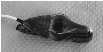
Bild 2: DMS Positionen auf Rollenschlepphebel
