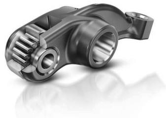
Bild 5: mech. Kippehebel mit Nockenrolle und hohlem Bolzen
