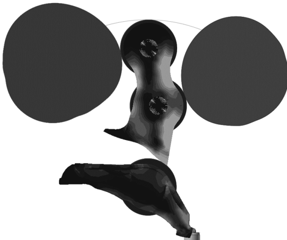
Bild 7: Deformation der Hebel aus der Co-Simulation einer Mehrkörpersimulation sowie einer strukturellen Analyse zum Zeitpunkt des Maximalhubs. Weiß: maximale Deformation, Schwarz: minimale Deformation
