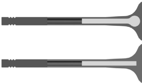
Bild 12: Typisches Hohlventil (unten) vs. MAHLE EvoTherm® Ventil (oben)
