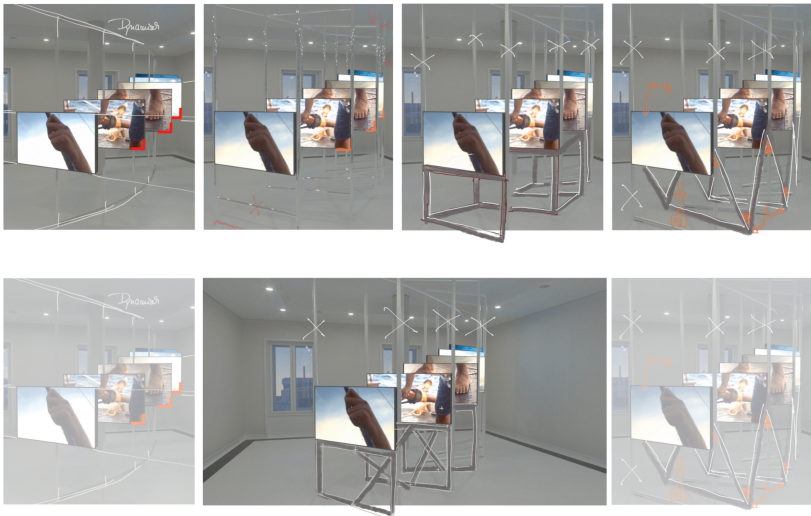
Abb. 7: Entwurfsskizzen — rechts oben zeigt sich die Behändigkeit der sehr soliden Struktur; unten in der Mitte der erste Entwurf, der Rechteckrahmen mit einer gekreuzten Struktur verbindet. Die roten Ecken — potenzielle Gefahrenpunkte für Verletzungen — zeigen, warum die Screens auf voller Breite durch ein Gestell aufgenommen werden mussten.
