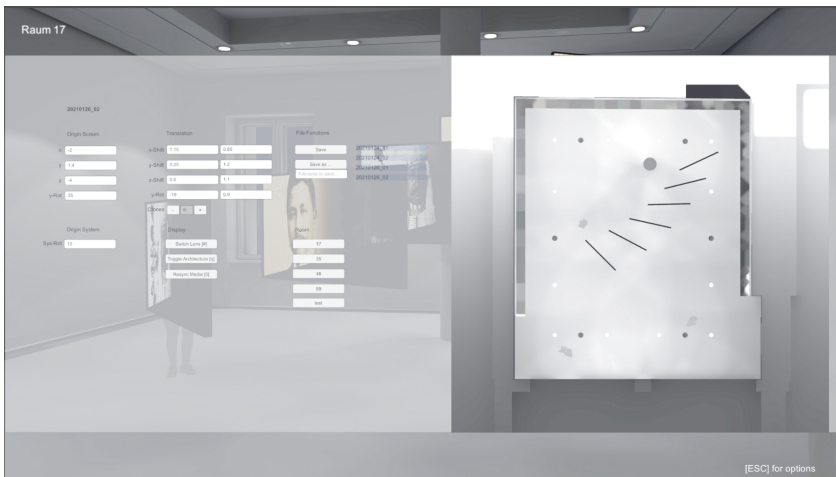
Abb. 6: Gestaltungsinterface in der Echtzeit Anwendung: Werte für Position und Rotation der Bildmedien können ›im laufenden Betrieb‹ verändert und optimiert werden. Zur Orientierung wird in dieser Bildschirmansicht auch ein Grundriss des Raumes mit deutlich sichtbaren Bildmedienpositionen im Kontext der Säule(n) dargestellt.
