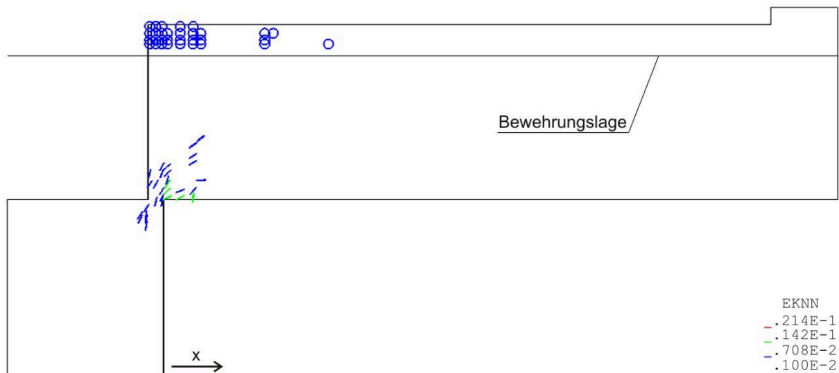
Bild 3-64: Platte P1-H-450, Rissbildung in der Symmetrieebene auf der X-Achse im Bruchzustand
