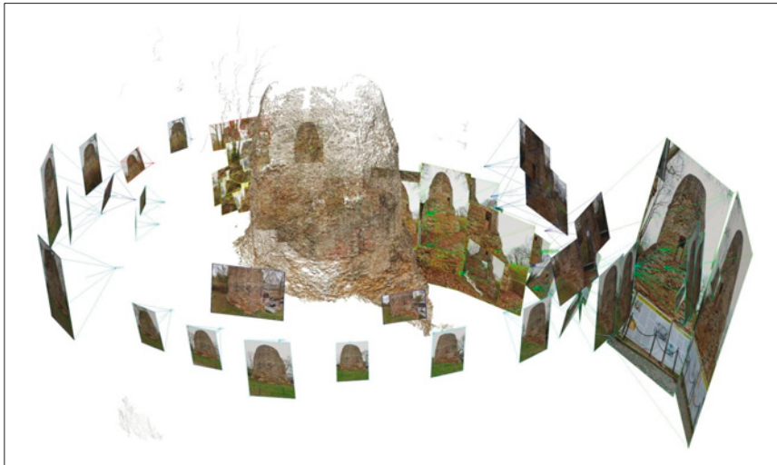
Abb. 13: Prinzip SfM am Drususstein in Mainz, mit einer Auswahl der verwendeten Bilder und die 3D-Punktwolke
