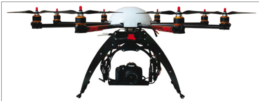
Abb. 10: Oktokopter als Kameraträger
