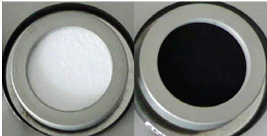
Abbildung 14: Filter einer DME-Messung im Graben, links neuer Filter, rechts Filter nach 30 min
