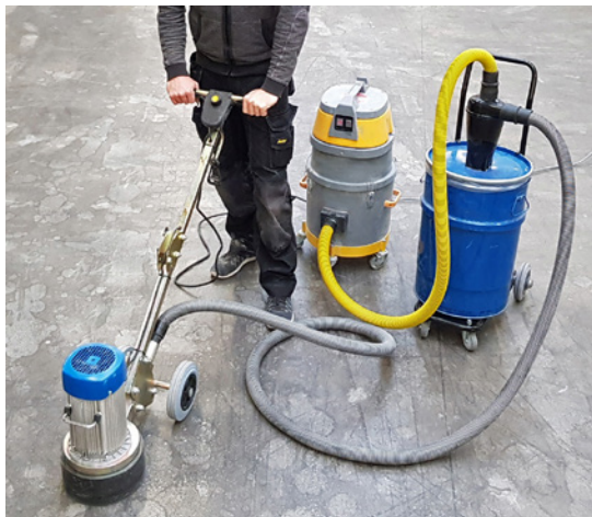
Abbildung 22: Vorabscheider (rechts) und Bau-Entstauber (mitte) beim Einsatz einer Bodenschleifmaschine
