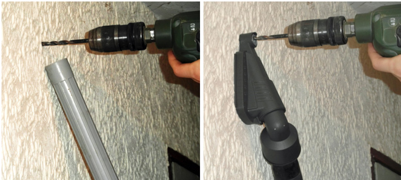
Abbildung 19: So kennt man das – die Staubsaugerdüse wird unter bzw. neben das Bohrloch gehalten (links), rechts mit Absaugglocke
