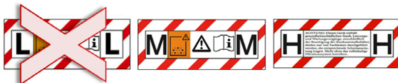
Abbildung 18: Kennzeichnung von L-, M- und H-Saugern nach DIN EN 60335-2-69, Anhang AA; L-Sauger sind nicht zulässig
