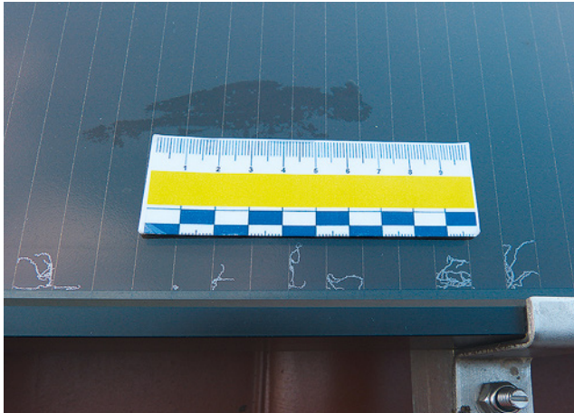
Bild 103: thermische Überbeanspruchung bei Dünnschichtmodule (leicht verwechselbar mit »TCO-Korrosion«)
