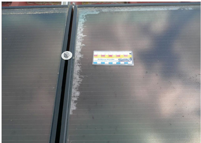
Bild 92: TCO-Schädigung im Modulrandbereich
