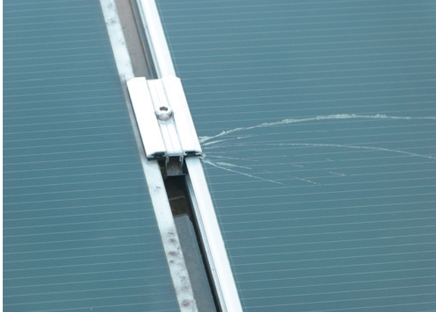
Bild 101: Spannungsriss im Glas an Klemmverbindung
