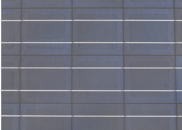
Bild 96: Zellen mit rahmenähnlichen Verfärbungen (»Framing«) durch Sauerstoffbleiche
