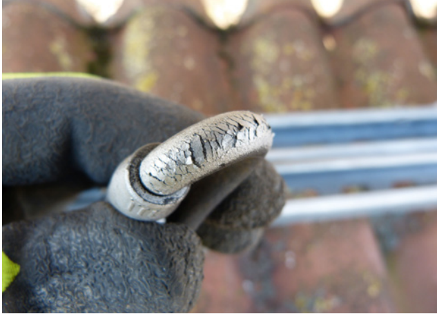
Bild 61: durch UV-Einwirkung poröser Leitungsmantel
