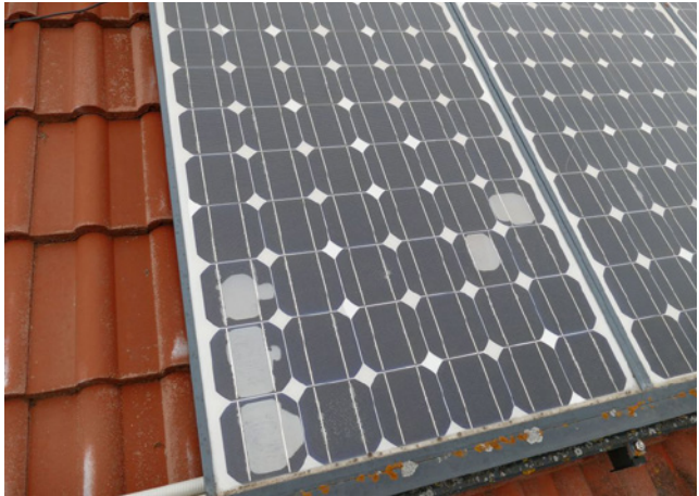
Bild 97: Delamination im Zellbereich
