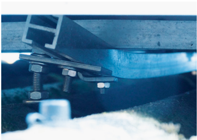
Bild 28: deformierte Tragschiene infolge zu weiter Befestigungsabstände
