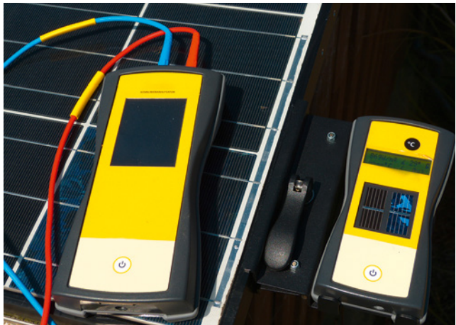
Bild 169: Kennlinienmessgerät (links) mit Einstrahlungs- und Temperatursensor (rechts)
