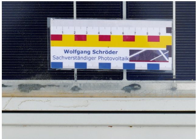
Bild 100: gerissene Rückseitenfolie mit Delamination und Korrosionen an Leiterbändern
