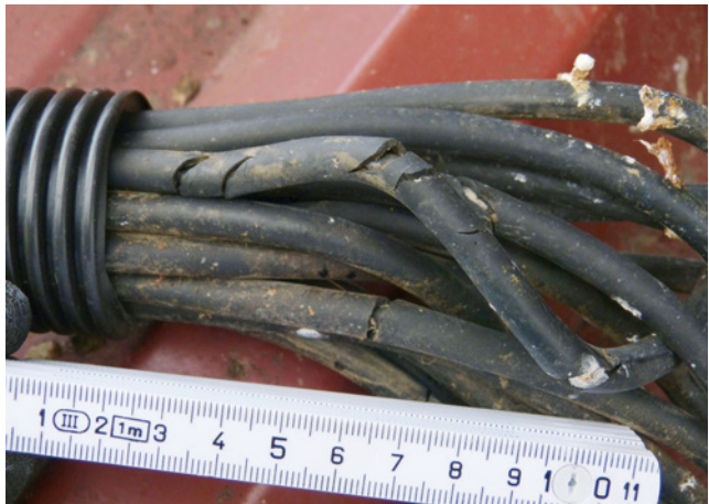
Bild 82: durch Witte- rung aufgeplatzte Gummischlauchleitungen
