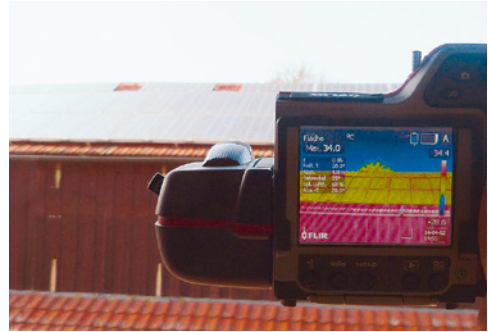
Bild 161: Wärmebildaufnahme bei Photovoltaikanlagen
