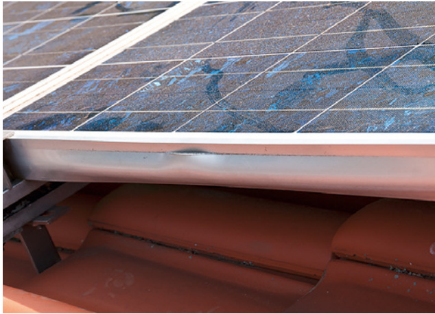
Bild 112: Frostscha- den am Rahmen
