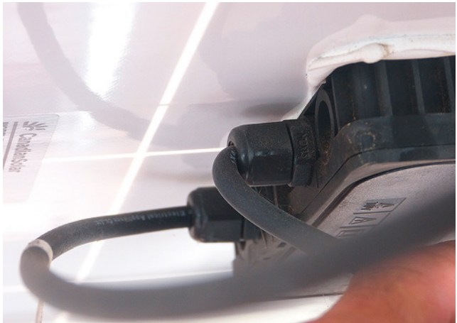
Bild 73: Überbeanspruchung der Kabeleinführung an der Anschlussdose
