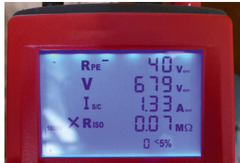
Bild 160: PV-Testgerät mit Multifunktionsanzeige, bei diesem Beispiel gemessener Isolationswert zu niedrig
