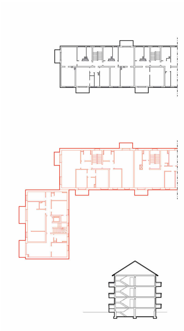
Abb. 38: Grundrisse & Schnitte Bestand – Aufstockung & Anbau 1, Ziekowkiez
