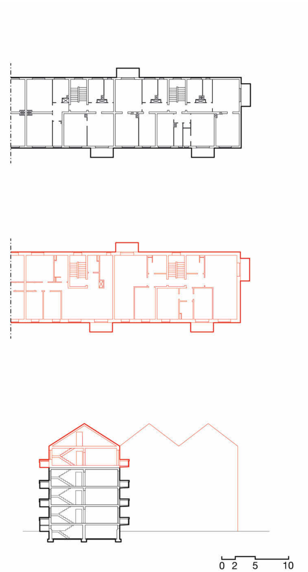
Abb. 39: Grundrisse & Schnitte Bestand – Aufstockung & Anbau 2, Ziekowkiez
