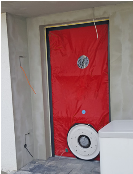
Abb. 4-41 Blower-Door-Messung in einem Hauseingang (Bauing und IMM Ingenieurbüro Güven Bulut, Wuppertal)
