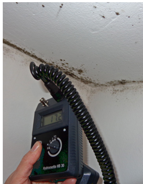
Abb. 6-12 Innenecke als Wärmebrücke zum unbeheizten Dachraum mit Schimmelpilzbefall
