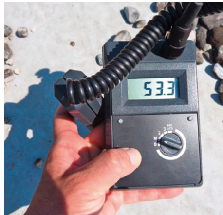
Abb. 10-24 Oberflächentemperatur auf einem gedämmten Flachdach mit grauer Kunststofffolienabdichtung (Zeitpunkt: Mitte Juli, ca. 15.30 Uhr)
