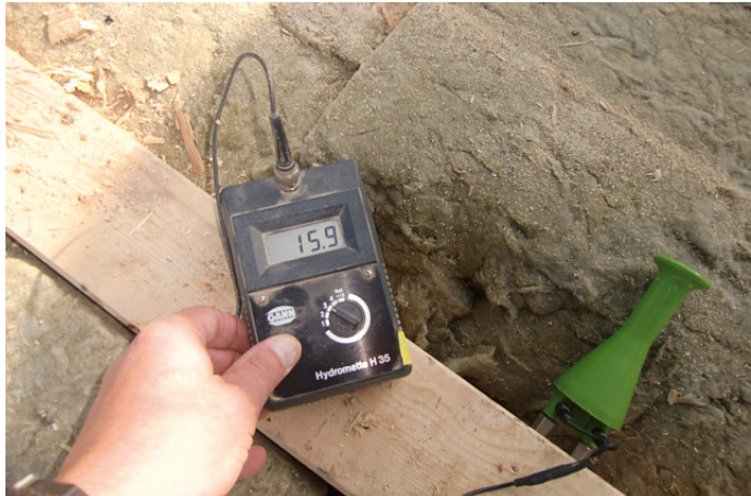
Abb. 4-34 Messung von Holzfeuchte an einem freiliegenden Sparren
