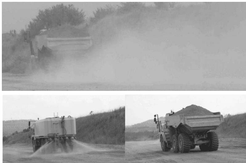
Bild 2: Staubentstehung (oben) und Staubunterdrückung mit Wasser (unten) auf einem unbefestigten Fahrweg
