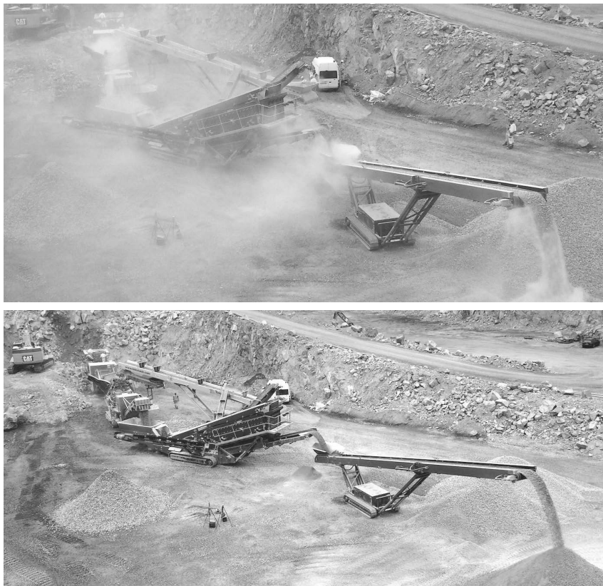
Bild 7: Brechen von Granit ohne (oben ) und mit (unten) Wasserbedüsung [15]
