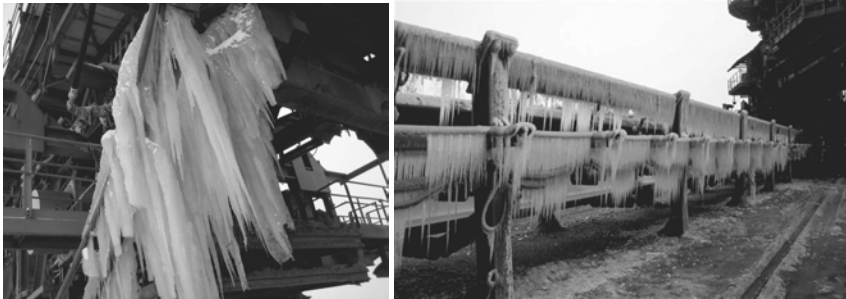
Bild 6: Vereisung an Bandanlagen während des Winterbetriebes geeigneter Sprühsysteme [10]
