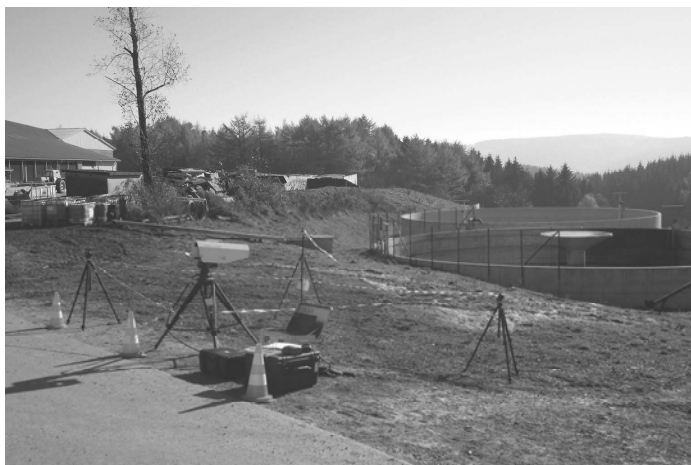
Bild 2: Emissionsmessung an einem offenen Gärrestlager mittels tunable diode absorption spectroscopy (TDLAS). (Foto: © Carsten Tilch (DBFZ)).
