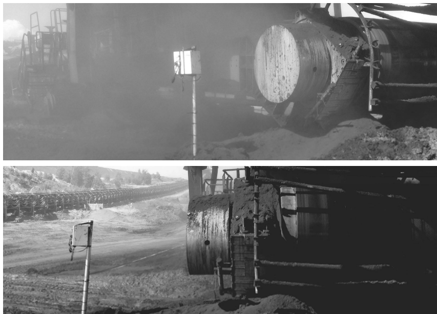
Bild 4: Übergabestation mit ausgeschalteter (oben) und eingeschalteter (unten) Normaldruckbedüsung
