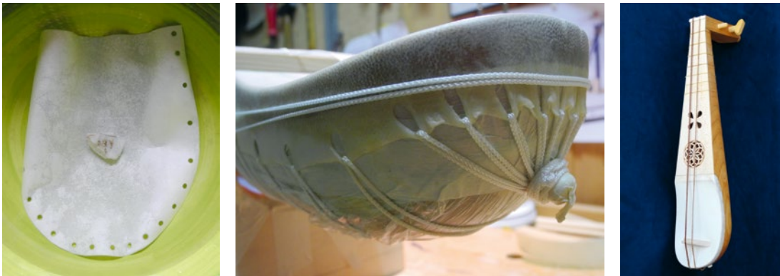
Abb. 27–29 Einweichen des Pergaments; Spannen und Aufleimen der Felldecke; fertiges Instrument (Fotos 21–29: T. Hirsch 2021).
