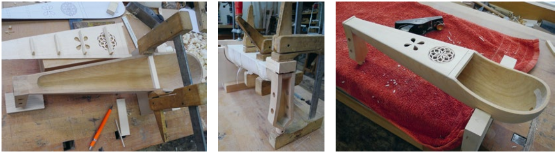
Abb. 24–26 Ein- und Aufleimen der Balken; Aufleimen des oberen Deckenteils; Vorbereitung der Leimflächen der Felldecke.
