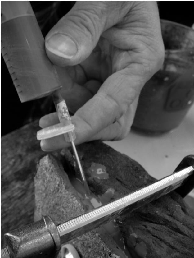
Abb. 8: Zwei Ziegelscherben wurden aneinander gefügt und der Zwischenraum mit dem Injektionsmörtel vergossen.
