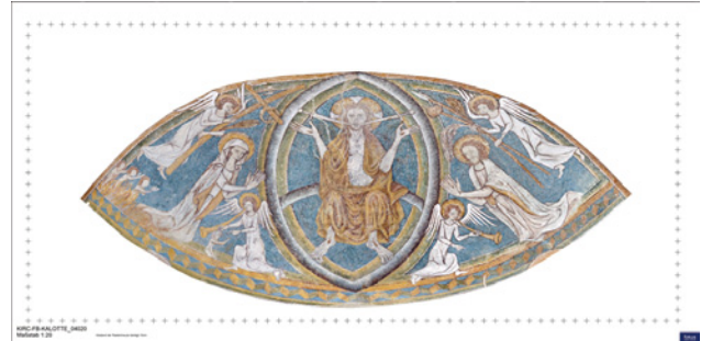
Abb. 13: links: orientiertes Bild der Kalotte mit Projektion des Zylinders; rechts: abgewickelter Bildplan der Kalotte (Orthogonale Projektion auf den Zylinder); Burg Katzenstein, fokus GmbH Leipzig
