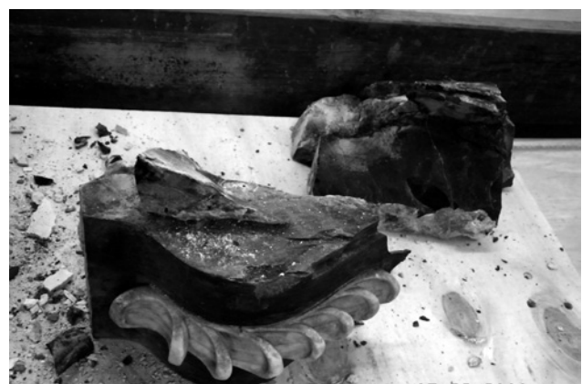
Abb. 21: Strukturschädigung am Kalkstein nach Demontage, Ulrichmonument
