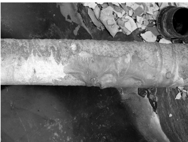
Abb. 7: Muster 2 – Gewebestrumpf frei aufgepumpt
