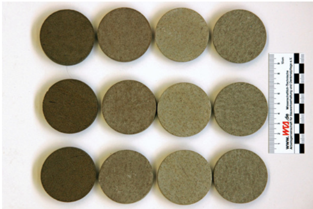
Abb. 8: Schilfsandstein, bauzeitliches Material, starke Zunahme der Farbvertiefung von nicht hydrophobierten Scheiben (rechts), Althydrophobie, einmal neu hydrophobiert, zweimal neu hydrophobiert (links). Alle Aufnahmen nach vollständiger Trocknung bis zur Massekonstanz der Scheiben im Klima 23 °C/50 % r. F.
