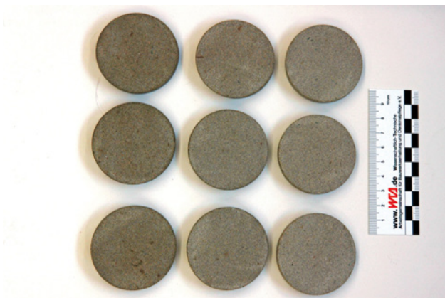
Abb. 10: Sander Schilfsandstein, neues Ersatzmaterial, Zunahme der Farbvertiefung von nicht hydrophobierten Scheiben (rechts), einmal hydrophobiert, zweimal hydrophobiert (links).
