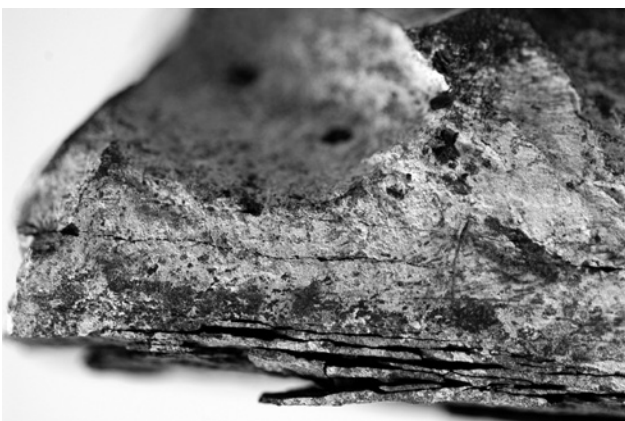
Abb. 20: Schichtaufspaltung und Krusten am Kalkstein, Bodenplatten, Schlosskirche Schwerin
