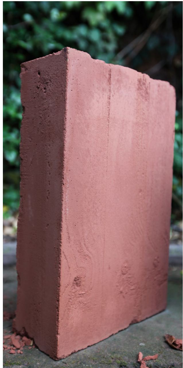
Abb. 15: Mörtelblock – gespritzt mit 27×42×9 cm
