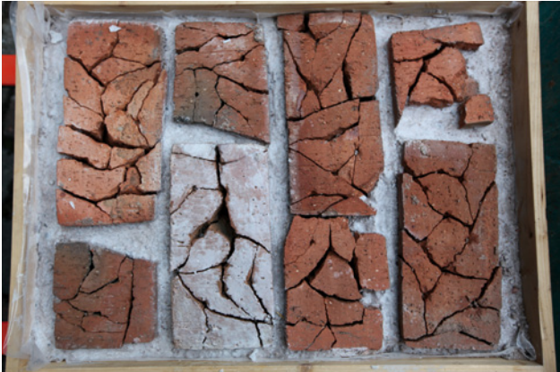
Abb. 12: Vorversuch mit zerschlagenen Vollziegeln in einem Holzkasten. Die Fugen und eine Ziegeloberfläche sind mit Cyclododecan beschichtet.
