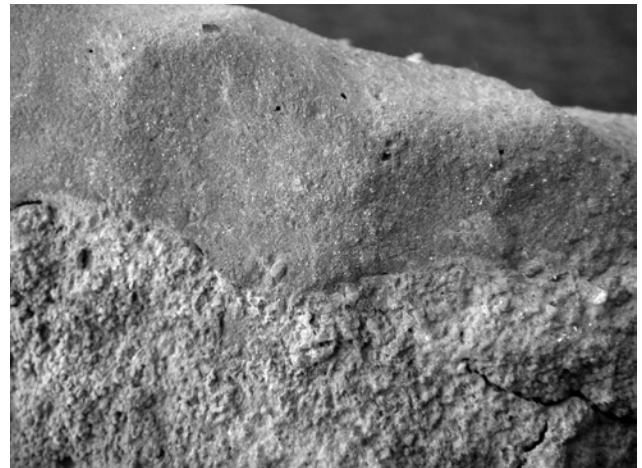
Abb. 9: Die Ersatzmasse wurde an einem Ziegelscherben angetragen, die entstandene Sinterhaut wurde nach ca. 12 Stunden im Niederdruck-Strahlverfahren entfernt. Dabei konnte die gealterte Ziegeloberfläche völlig unbeschädigt erhalten werden.
