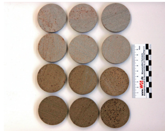
Abb. 11: Kordeler Sandstein, Zunahme der Farbvertiefung von nicht hydrophobierten Scheiben (oben), Althydrophobie, einmal neu hydrophobiert, zweimal neu hydrophobiert (unten).
