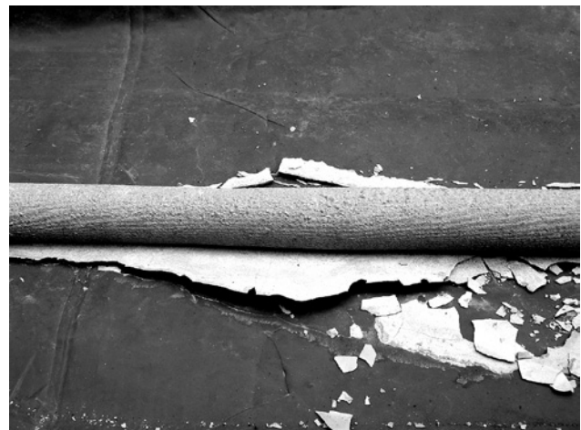
Abb. 6: Muster 1 – Gewebestrumpf im HT-Rohr ausgeschalt
