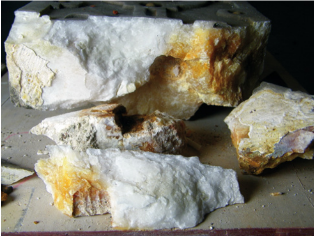
Abb. 9: Rostschädigung mit Brüchen am Alabaster, Ulrichmonument
