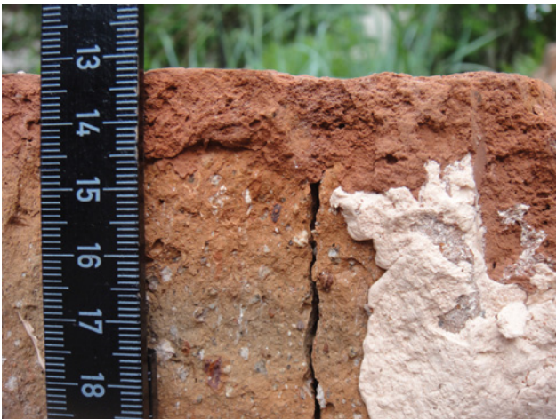
Abb. 14: Die Ziegelbruchstelle zeigt die Eindringtiefe der gespritzten Antragsmasse in einen Riss von 2 bis 3 mm. (Daneben die hellere Injektionsmasse)
