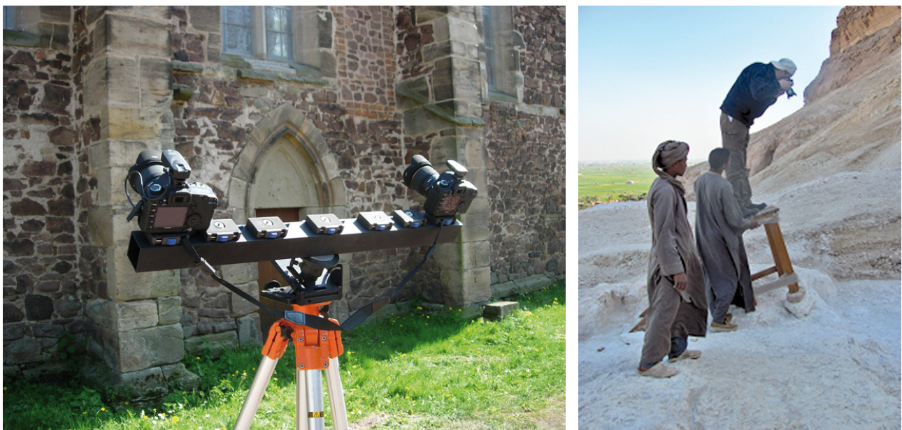
Abb. 9: Aufnahmeschiene für Stereomodelle mit definierter Basis (links); Bildaufnahme von Hand (rechts)
