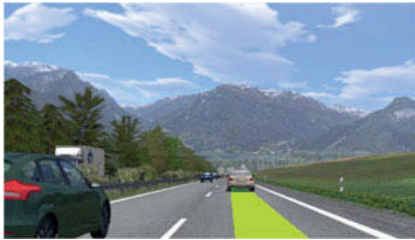
Bild 2: Darstellung des Sicherheitsabstandes in Form eines transparenten Balkens auf der Straße, wenn der Sicherheitsabstand eingehalten wird (links) und wenn der Sicherheitsabstand unterschritten wird (rechts).
