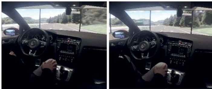
Bild 2: Kurvenfahrt im Landstraßenabschnitt mit stillstehendem Lenkrad (links) und mitdrehendem Lenkrad (rechts)
