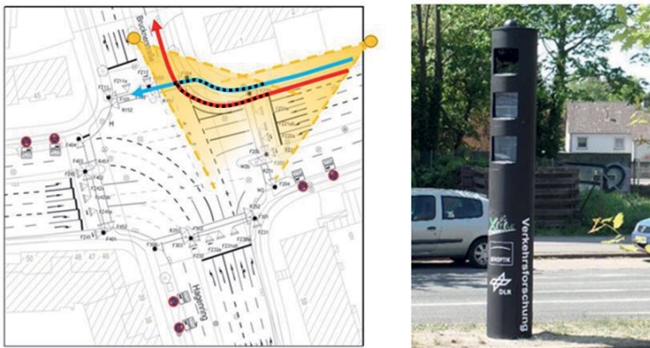
Abbildung 1: Links: Schematische Darstellung der Kreuzung, Erfassungsbereich (gelbe Kegel), Position der Säulen (gelbe Punkte) und Bewegungspfade von Radfahrenden (blau) und Autofahrenden (rot). Rechts: Gehäuse für Sensoren zur Erfassung von Verkehrsteilnehmenden.
