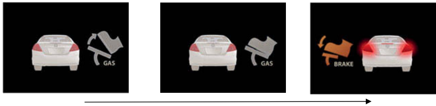
Bild 3: Darstellung auf dem Beifahrerdisplay, wenn der Fahrer Gas gibt (links), wenn er den Fuß vom Gaspedal nimmt (mitte) und bei einem stärkeren Bremsmanöver (rechts).
