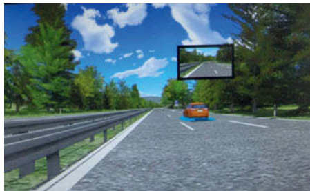
Bild 1: Umsetzung der Kennzeichnung des automatisierten Fahrmodus im Fahrsimulator
