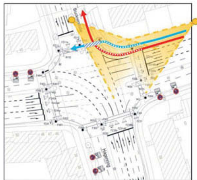
Abbildung 2: Schematische Darstellung der Abschnitte. Die gestrichelten weißen Linien korrespondieren mit dem Abbiegebereich. Das straffierte Kästchen stellt den Kreuzungsbereich bzw. die Konfliktzone dar.
