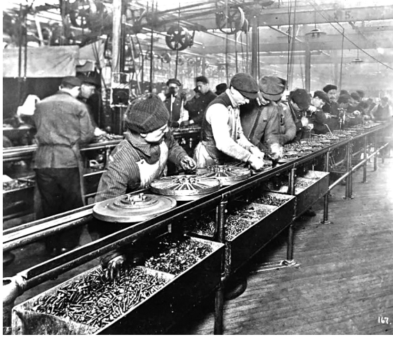
Abbildung 9: „Flywheel Magneto“-Montagelinie, Highland Park (1913)
