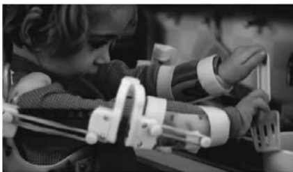
Bild 13: Exoskelett, Extrusionsverfahren, FDM.
