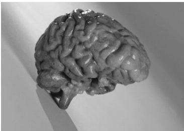
Bild 8: Brain, Schicht-Laminat Verfahren. Papier, farbig.
