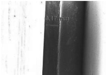
Bild 4: Unter der Lupe: Eine Schweißnaht aus dem Laser-Durchstrahlsschweißen.
