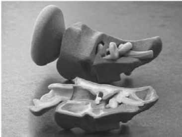
Bild 7: Pulver-Binder Verfahren (3DP), Geschnittenes Ohrmodell.
