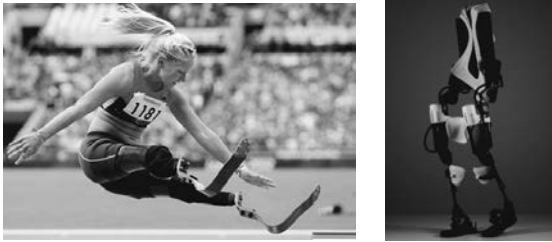
Bild 15: Hochleistungsprothesen, kohlefaser-verstärkt (Otto Bock, links) und Exoskelett (3D Systems, rechts)
