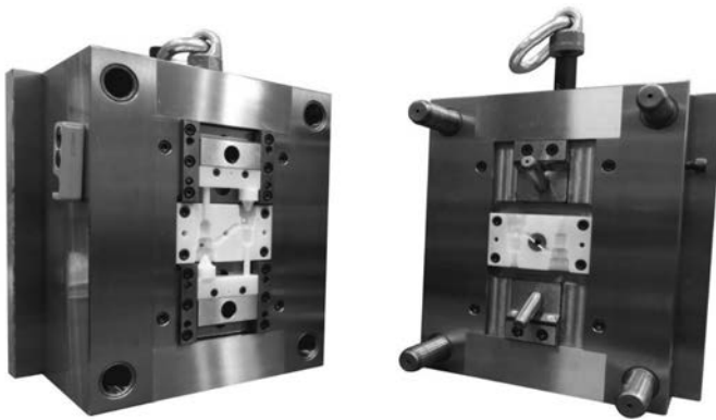
Bild 7: Rapid-Tooling-Konzept mit 3D-gedruckten Werkzeugeinsätzen zur Erstellung von Nullserien Bauteilen aus sogenannten Originalwerkstoffen (Bild: HASCO Hasenclever GmbH + Co KG)
