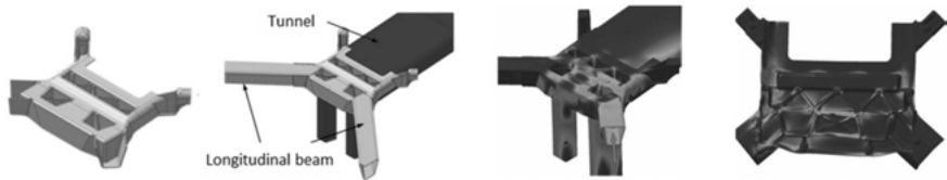
Bild 1: Links: Darstellung des einzelnen Gussteils und in isometrischer Ansicht in die Karosserie eingebautes Gussteil (Verbindung zu den Längsträgern und dem Tunnel). Rechts: Spannungsverteilung während eines Frontalaufpralls für die Baugruppe und das Gussteil.
