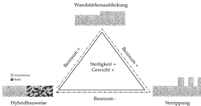
Bild 3: Konstruktionsmethoden zur lokalen Steifigkeitserhöhung von Gussbauteilen
