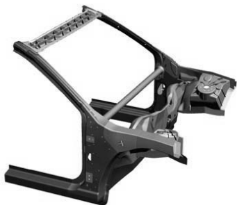
Bild 4: Nemak Konzeptstudie einer Vorderwagenstruktur basierend auf einem realen Fahrzeug und innovativem AI-Guss intensiven Hybrid- und MMD Design inklusive einer Lastfall Auslegung gemäß gängiger Sicherheitsanforderungen
