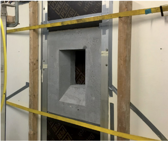
Bild 6-4 Prototyp im Schlagregenstand, zu beregnende Front (links) und Eindringtiefe der Feuchtigkeit kurz nach der Beregnung (rechts) [27]
