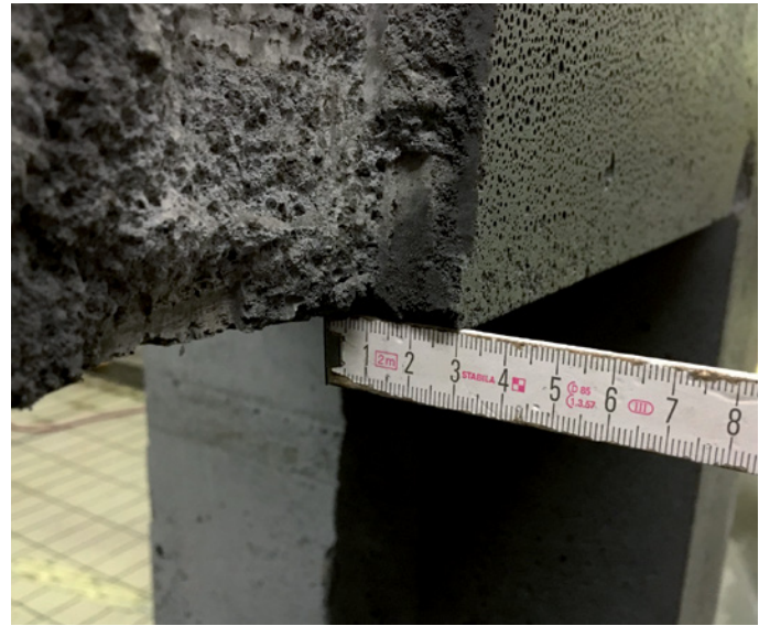
Bild 6-4 Prototyp im Schlagregenstand, zu beregnende Front (links) und Eindringtiefe der Feuchtigkeit kurz nach der Beregnung (rechts) [27]
