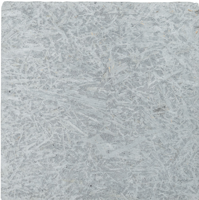
Bild 8-7 Oberfläche von ILC mit OSB-Schalung
