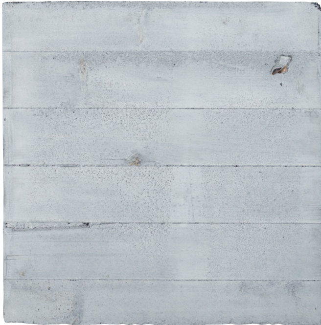
Bild 8-6 Oberfläche von ILC mit Brett Holzschalung
