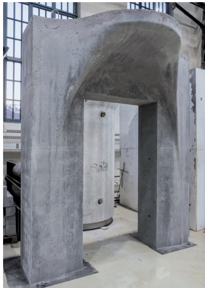
Bild 4-11 Prototyp eines Wandausschnitts mit Balkon aus ILC ohne Rückverankerung
