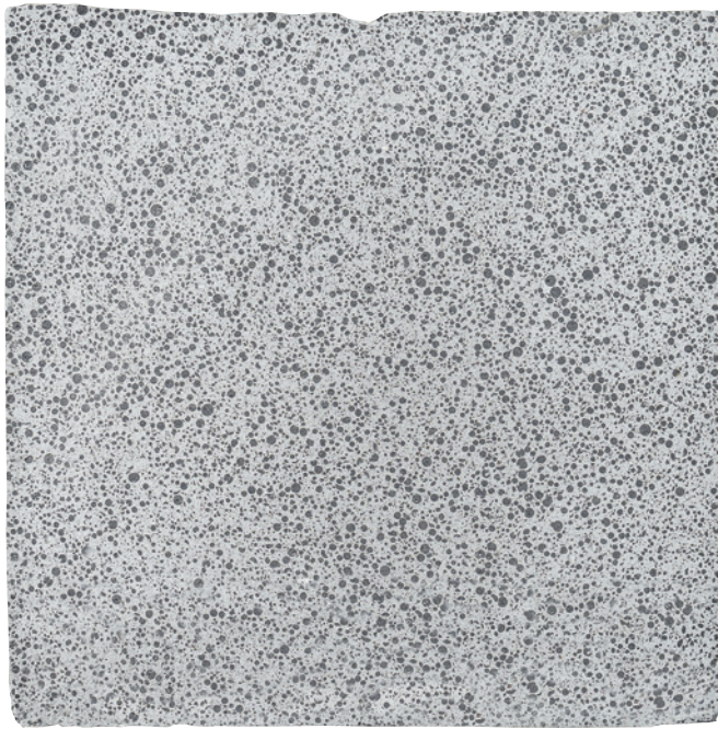
Bild 8-16 Freilegen der inneren Struktur des ILC durch Schleifen
