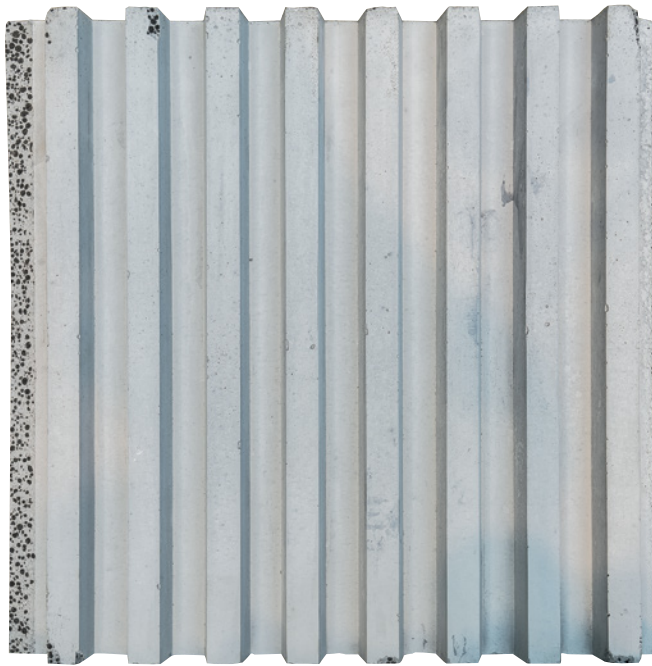
Bild 8-3 Oberfläche von ILC mit Rippenstruktur
