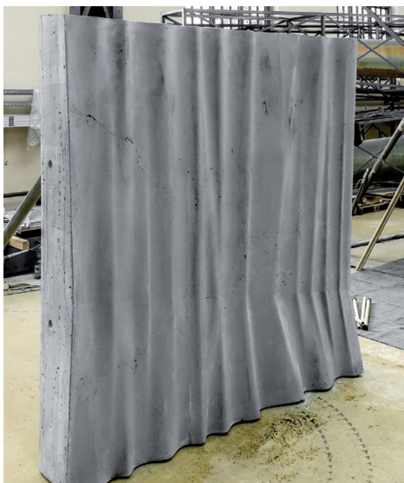
Bild 8-10 Prototyp hergestellt mit Polystyrol-Schalungskörper (Foto: Lukas Specks)
