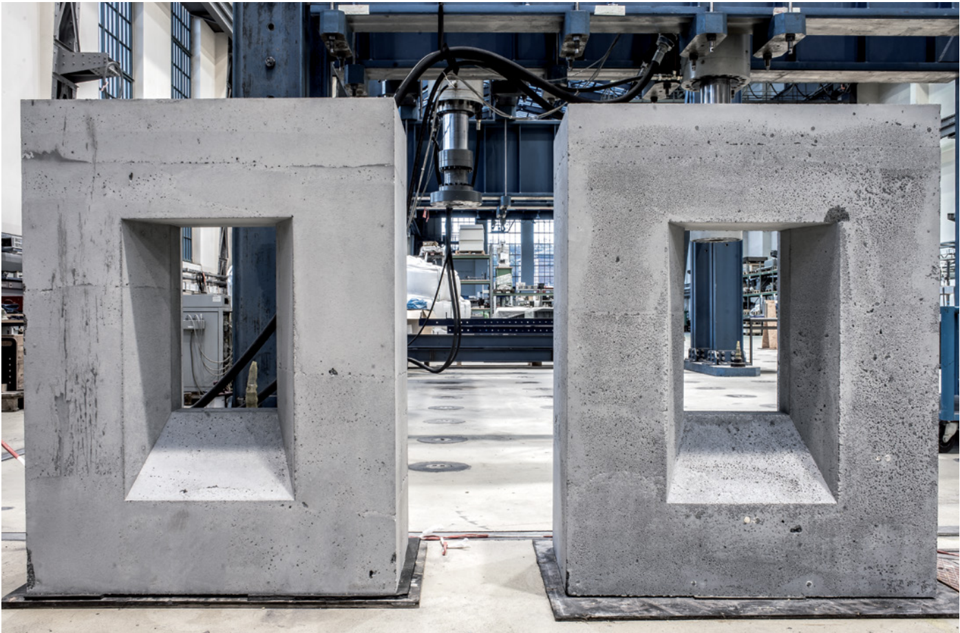
Bild 8-2 Prototypen und Oberflächen aus Infrleichtbeton, links: ILC800, rechts: ILC600
