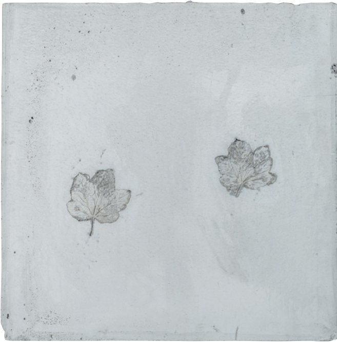
Bild 8-8 Oberfläche von ILC mit in die Schalung eingelegten natürlichen Blättern
