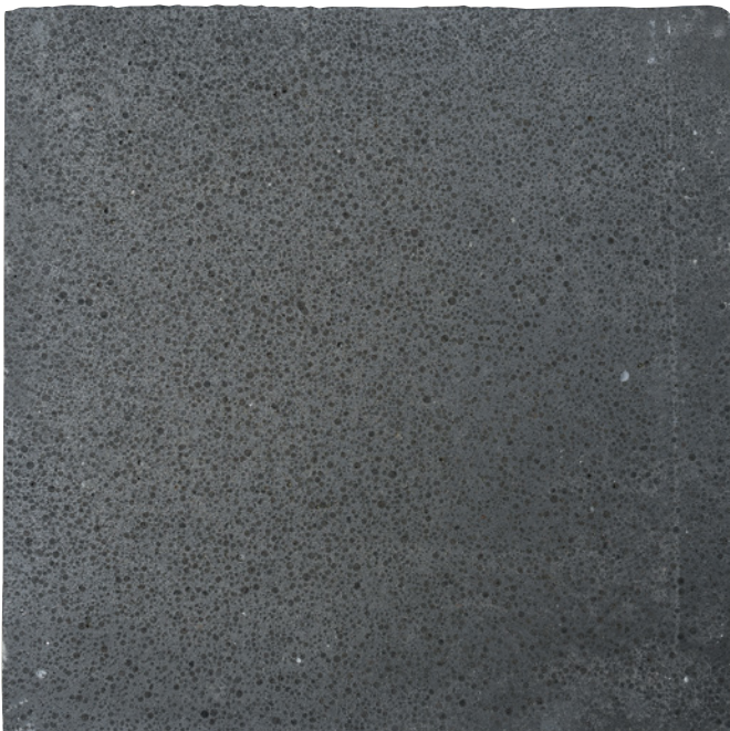
Bild 8-18 Versiegelung der freigelegten inneren Struktur durch Leinöl; prägnante Verfärbung des Materials
