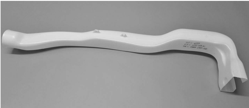
Bild 8: Mit expandierbaren Mikrosphären geschäumtes Blasformteil aus PE-LD mit komplexer Geometrie in Kooperation mit ‚Mergon International‘ aus Irland
