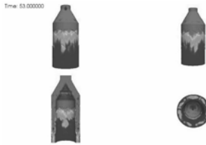
Bild 7: Die Simulation eines Farbwechsels von blau nach rot zeigt deutlich, dass mit Hilfe der Mischerstege Schmelze von der Mitte zu den Wänden umgelenkt wird
