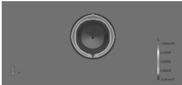
Bild 6: Die Simulation eines Farbwechsels von blau auf rot zeigt im Querschnitt des Fließkanals das charakteristische parabolische Fließgeschwindigkeitsprofil und die Störung, die durch den Blasluftkanal hervorgerufen wird
