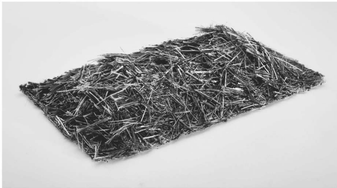
Bild 9: Preform aus fasergesprühten Hybridgarn
