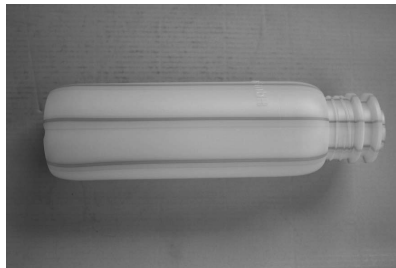
Bild 8: Versuchsflasche, die im Verlauf eines Farbwechselversuchs von rot eingefärbtem HDPE zu naturfarbenem in Extrusionsrichtung rote Streifen aufwies
