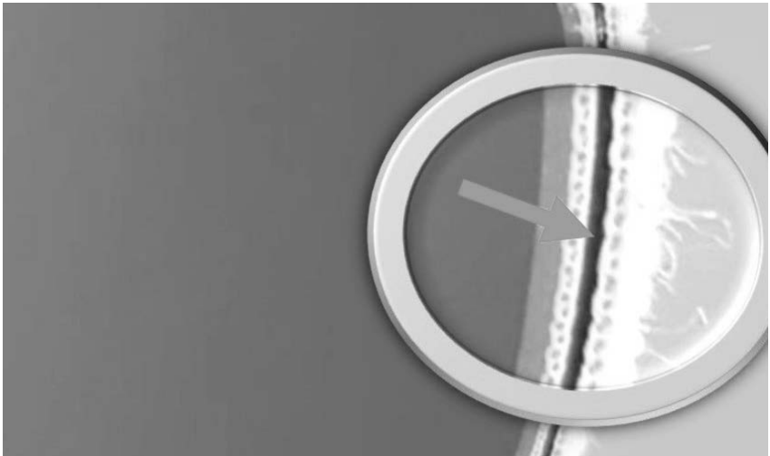
Bild 6: Mit expandierbaren Mikrosphären geschäumte Zwischenschicht eines Drucktuchs mit einer Schichtdicke von unter 800 \mu\text{m}
