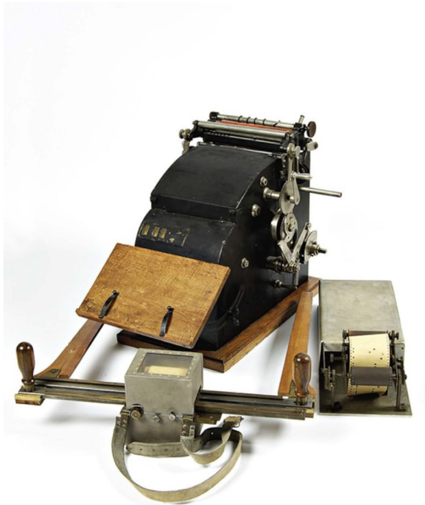
Abbildung 2.1: Frühe Rechenmaschine mit Messinstrument und Lochstreifengerät für die Erfassung und Verbuchung von Forstbeständen (1905–1952), 500 x 400 x 470 mm
