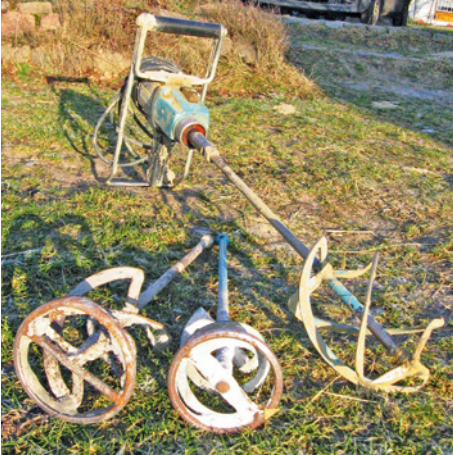
Rechts im Bild: Rührkorb ohne Schutzring
