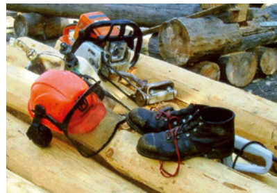
Holz schälen mit einem Schälvorsatz am Kettensägenmotor
