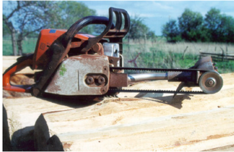
Schälvorsatz am Motor einer Kettensäge
