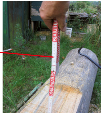
Laserwasserwaage (links); Auf dem Zollstock wird die Höhe mittels Laser abgemessen
