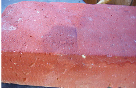
Der Teststein: die linke Seite wurde nicht geölt, die rechte Seite erhielt einen dreimaligen Halbölanstrich
