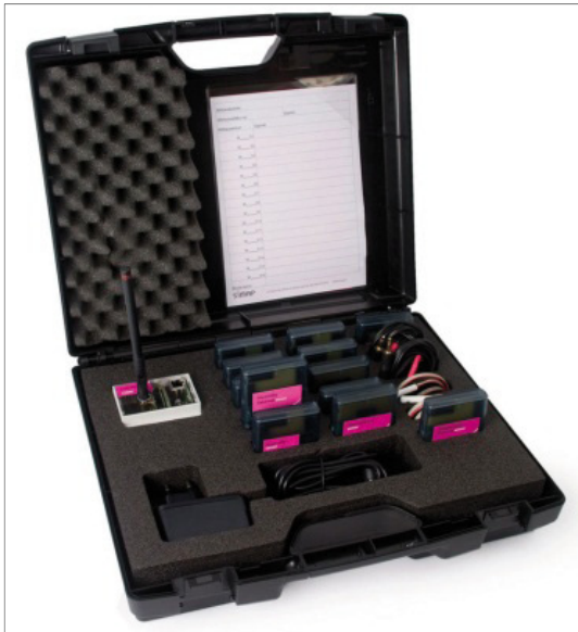
Abb. 3: Sendestation und W-Lan Messsensoren (Enersor GmbH)
