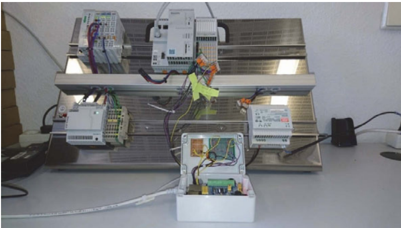
Abbildung 35: Experimentelle Anordnung mit XM21 und Raspberry-PI
