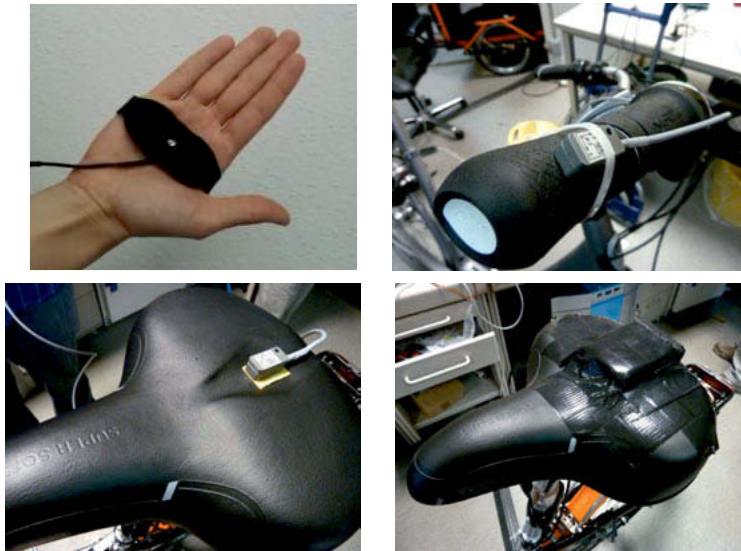
Bild 2: Sensorik zur Messung der Hand-Arm- (oben) und Ganzkörper-Vibrationen (unten)
