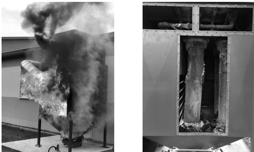
Bild 3: Patronenfilter während und nach dem Brand
