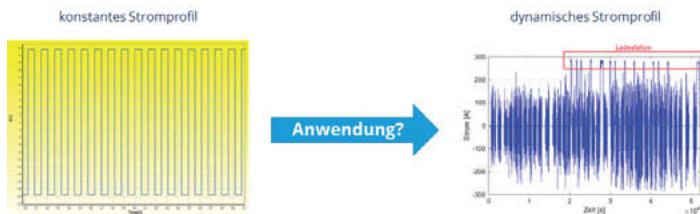
Bild 3: konstantes Stromprofil vs. realer Lastzyklus
