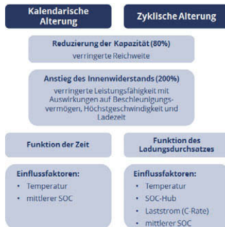
Bild 1: Übersicht Alterung von Li-Ionen Traktionsbatterien
