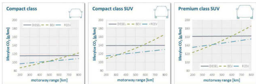
Bild 5: CO 2 -Bilanzen in Abhängigkeit von Autobahnreichweite und Fahrzeugsegment
