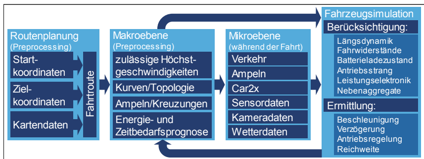
Bild 1: Programmstruktur der Gesamtfahrzeugsimulation
