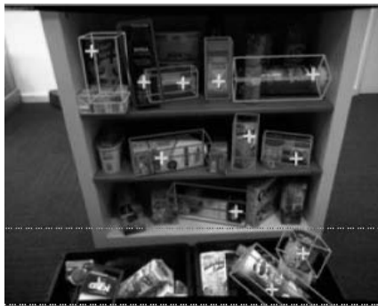
Bild 01: Über den Abgleich von eingelernten 3D-Modellen oder CAD-Daten identifiziert ein Roboter selbst bei ungünstigen Lichtverhältnissen ungeordnet herumliegende Objekte. (Bild: Fraunhofer IPA)
