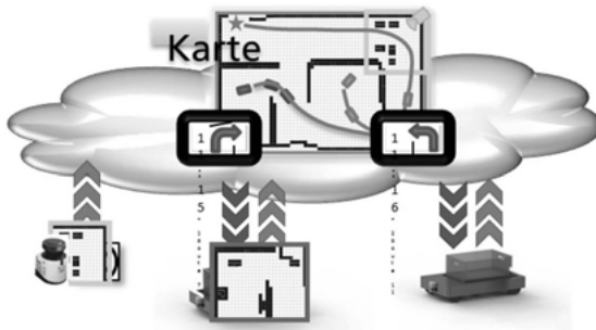
Bild 04: Über die Cloud miteinander vernetzte fahrerlose Transportfahrzeuge erstellen gemeinsam eine Umgebungskarte und verständigen sich bei drohenden Kollisionen über Ausweichrouten. (Grafik: Fraunhofer IPA)
