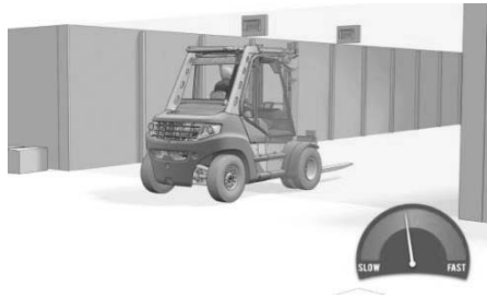
Bild 4: Schaubild zur Geschwindigkeitsreduzierung: Ein Stapler fährt in einen markierten Bereich ein
