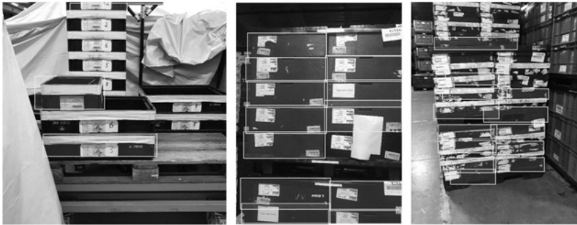
Abbildung 4.4: exemplarische Fehldetektionen aufgrund von Einflüssen industrieller Rahmenbedingungen
